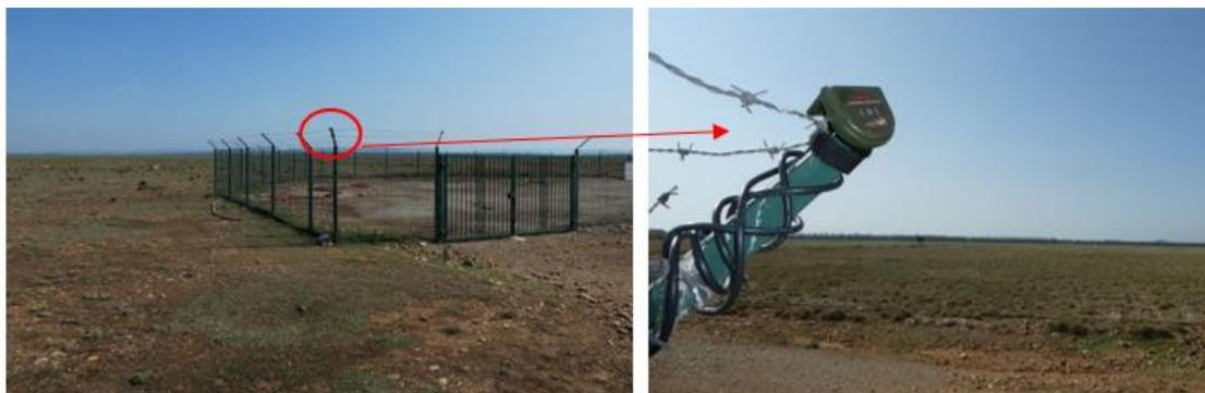
Figure 19 : Détecteur (SM4) à chiroptères installé dans l'aire d'étude. Photos sur site : Naturalia.
