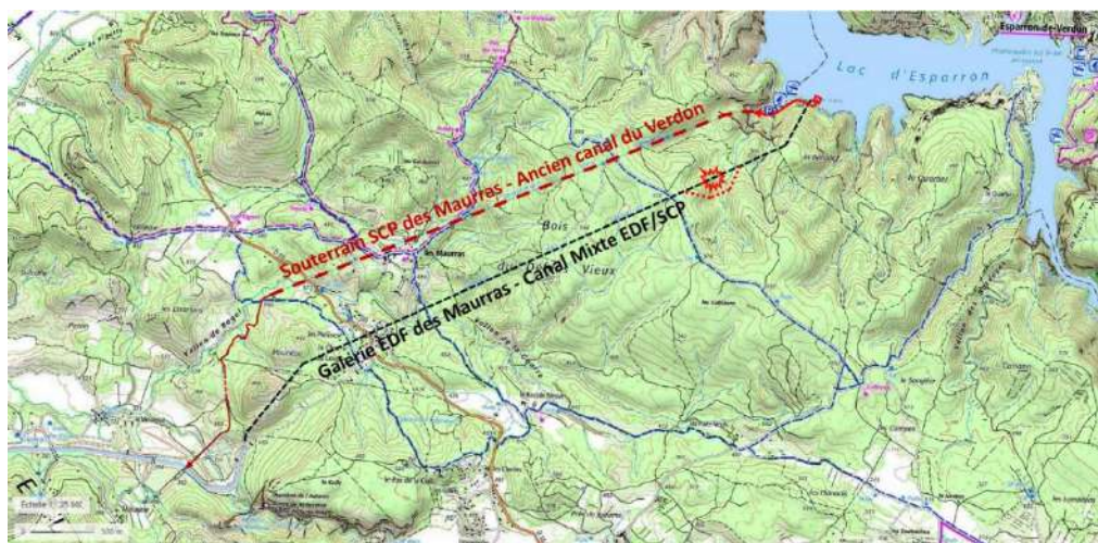
Principe du by-pass par la remise en eau d'une partie de l'ancien canal du Verdon
