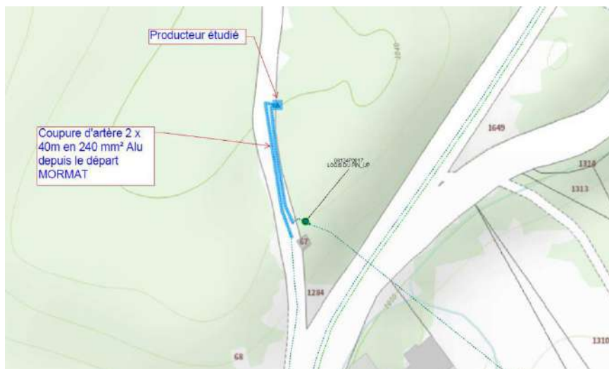
La longueur du raccordement au réseau de distribution électrique sera de 40 m. Source : Pré-étude simple réalisée par Enedis
