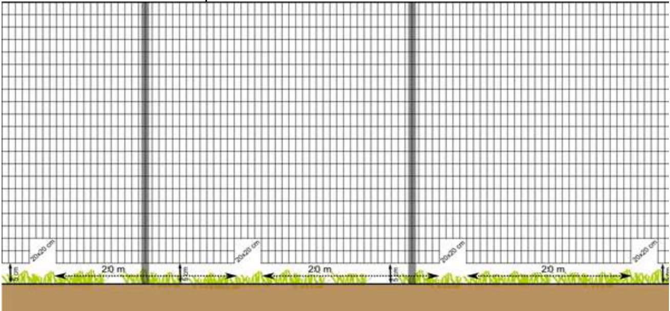
Schématisme d'une clôture modifiée pour permettre le passage de la faune. Source : ECOTER
