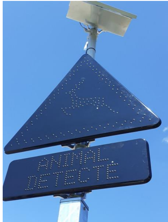
Figure 25 : : Panneau à message variable du dispositif. Ne s'allume que s'il y a un animal sur la chaussée détecté par le radar © Département de l'Ain
