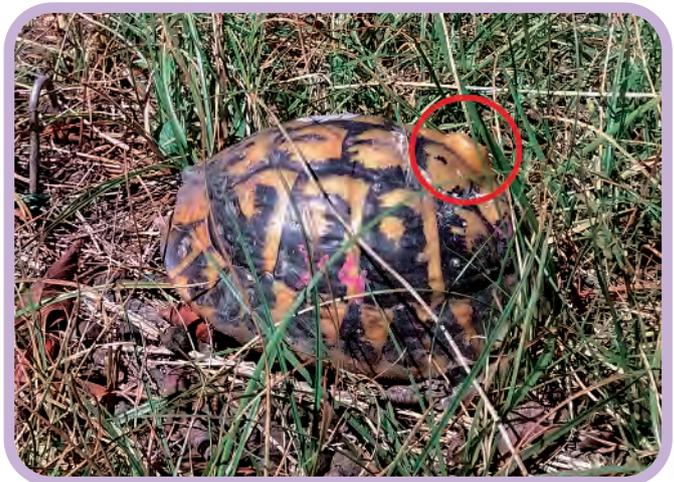
Modèle physique équipé d'un enregistreur de température
