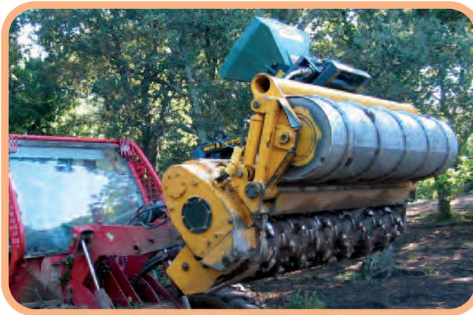
Gyrobroyeur à marteau et dessoucheur
