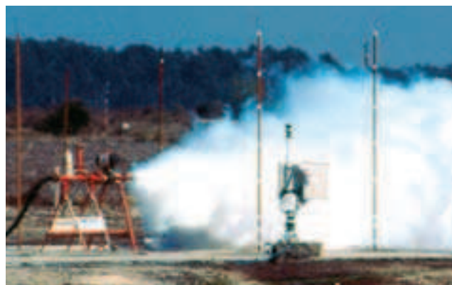
Fig. 6 - Essais INERIS de dispersion d'un nuage d'ammoniac à l'air libre.
