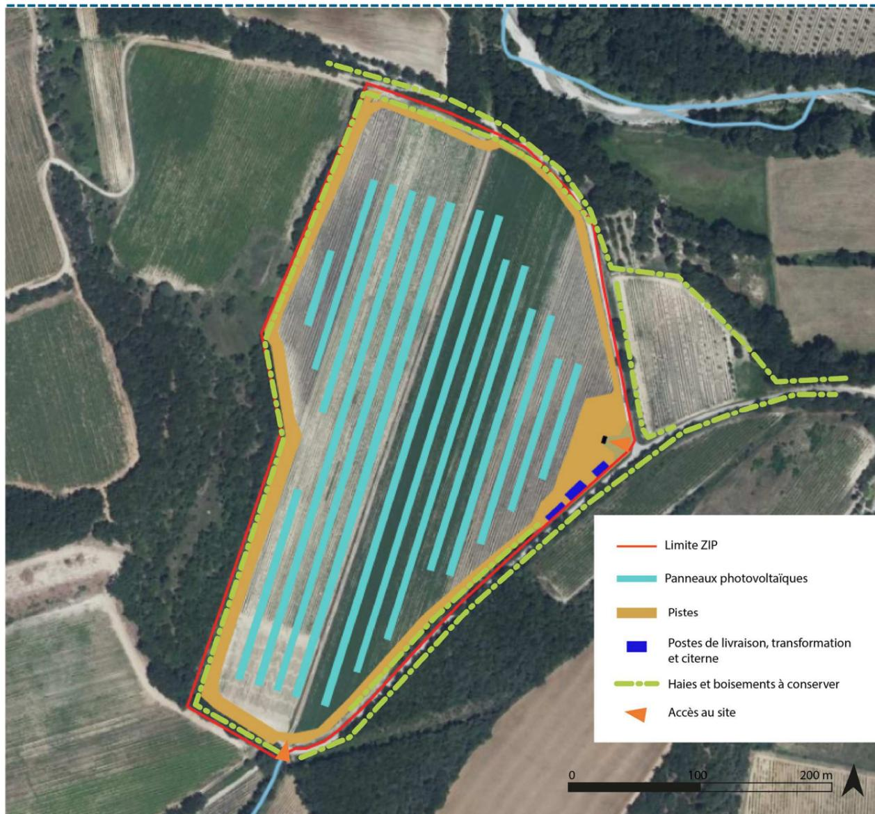
Figure 58 - Cartographie des mesures paysagères à mettre en œuvre
