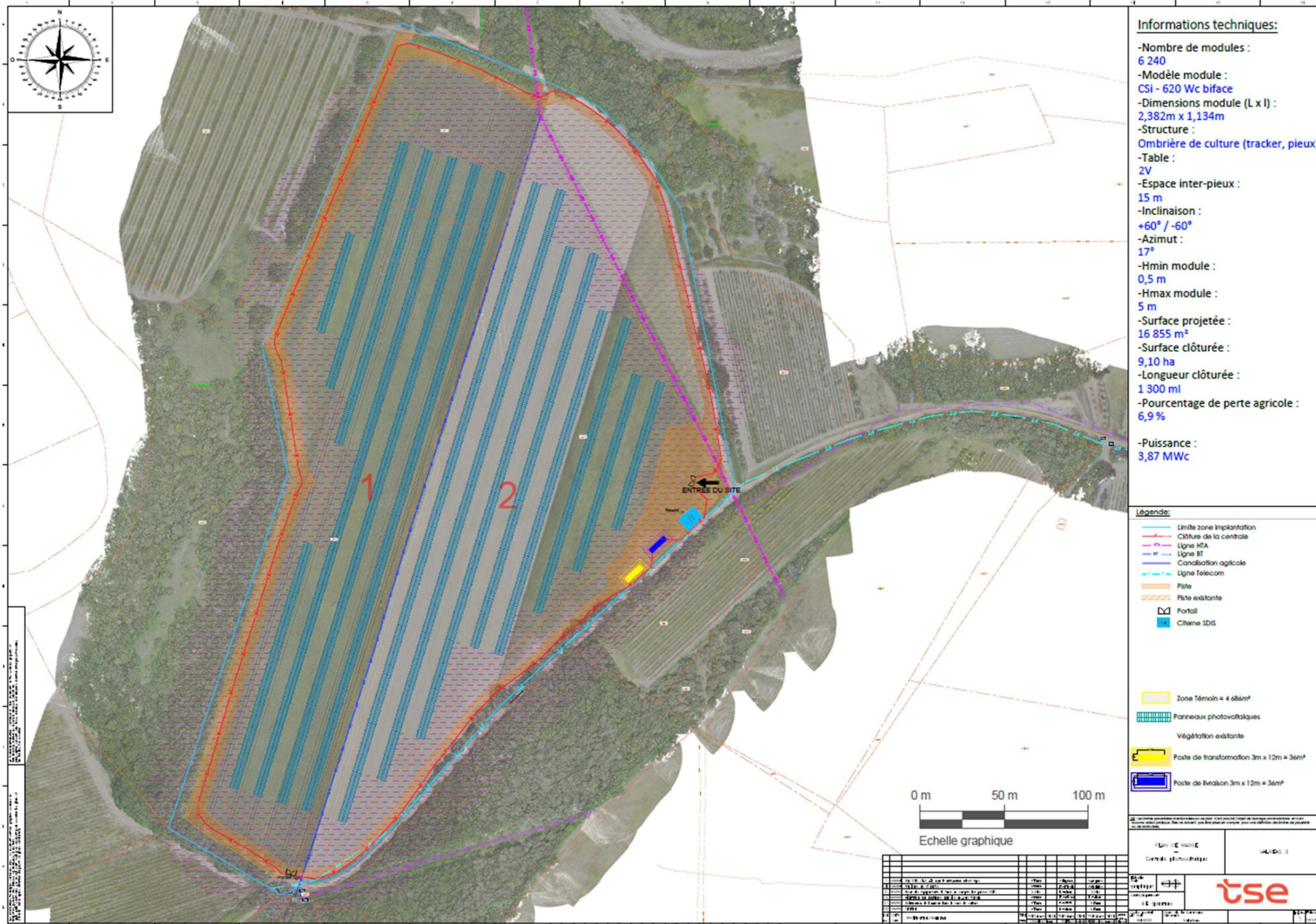
Figure 54 - Plan d'implantation des panneaux photovoltaïques et repère des coupes schématiques
