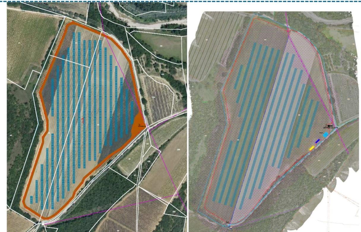
Figure 13 - Design VO (à gauche), Design VF (à droite) et comparaison des surfaces d'OLD (dessous)
