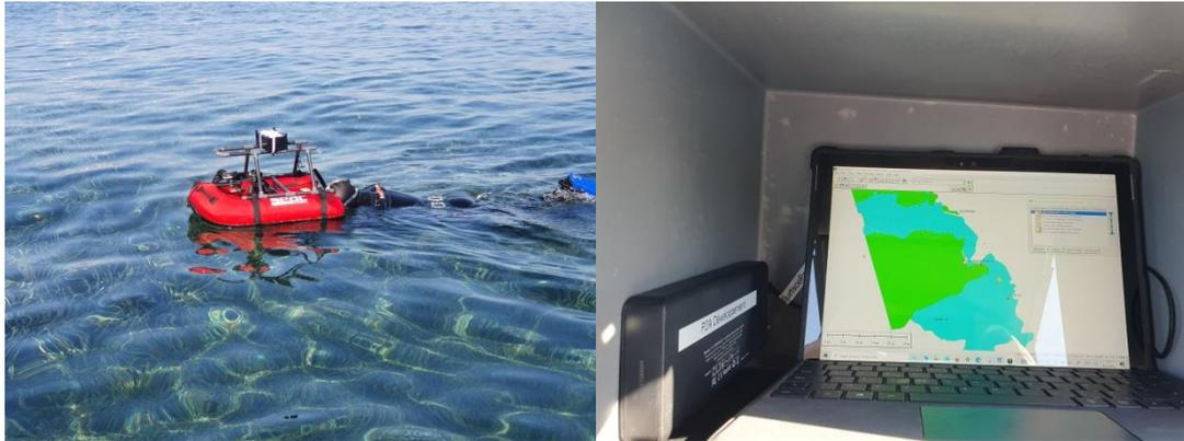
Figure 3 – Système de géoréférencement : DGPS flottant avec fil à plomb positionné par le plongeur + tablette équipé du logiciel de cartographie (P2A Développement).
