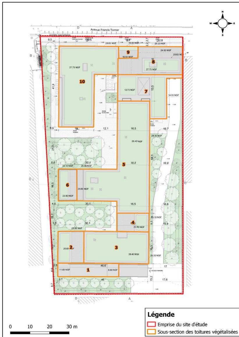
**Figure 5 : Sous-section de la toitures végétalisées considérées dans la suite du dimensionnement**
