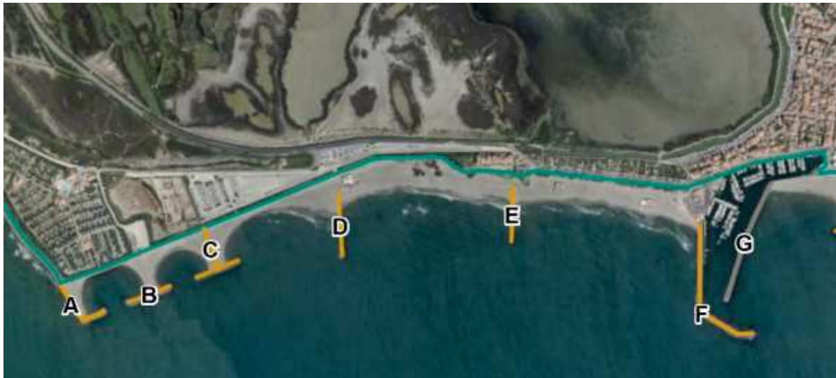
Figure 41. Cartographie des épis et brise lame au droit des Saintes Maries de la mer (1/2)
