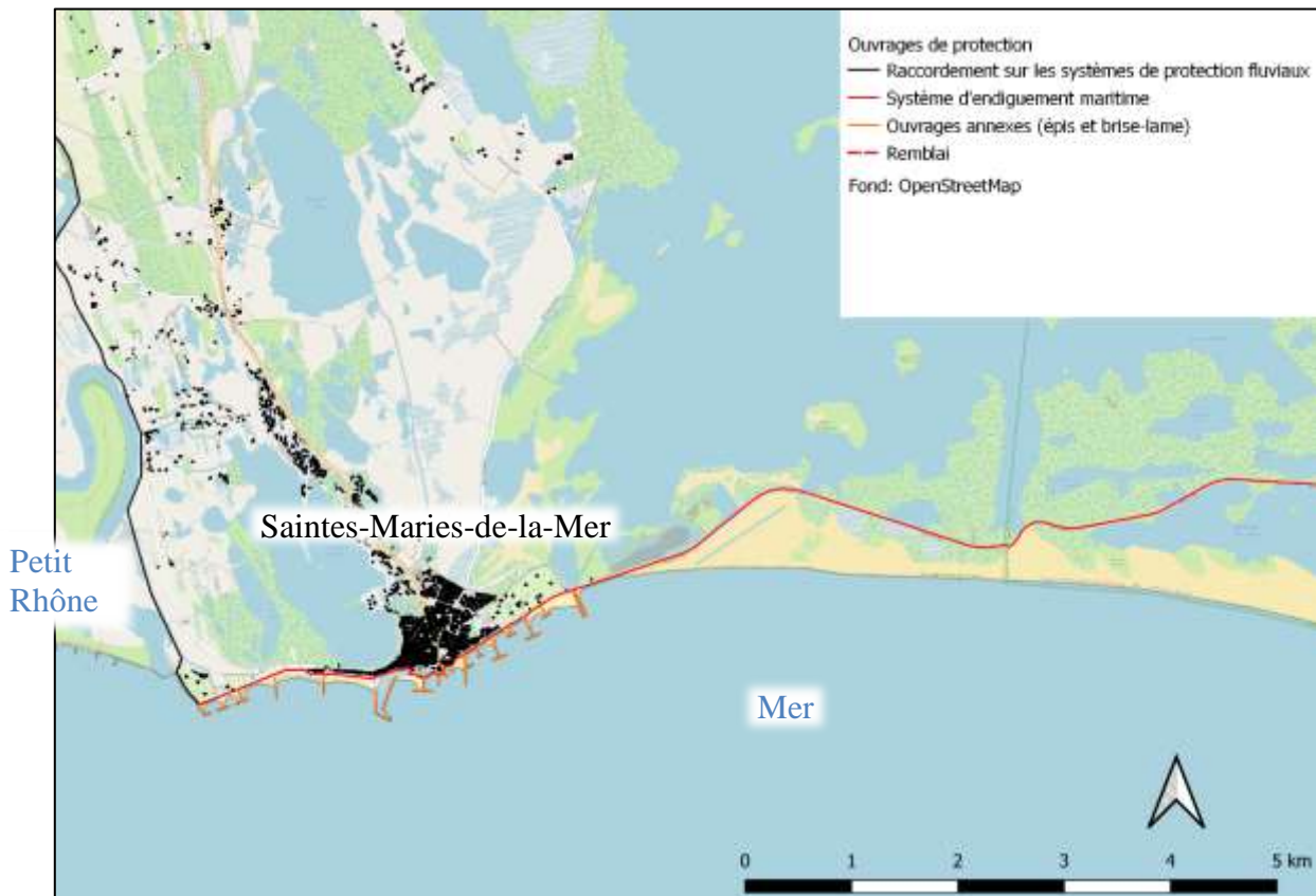
Figure 1. Localisation des ouvrages du système d'endiguement 1/3
