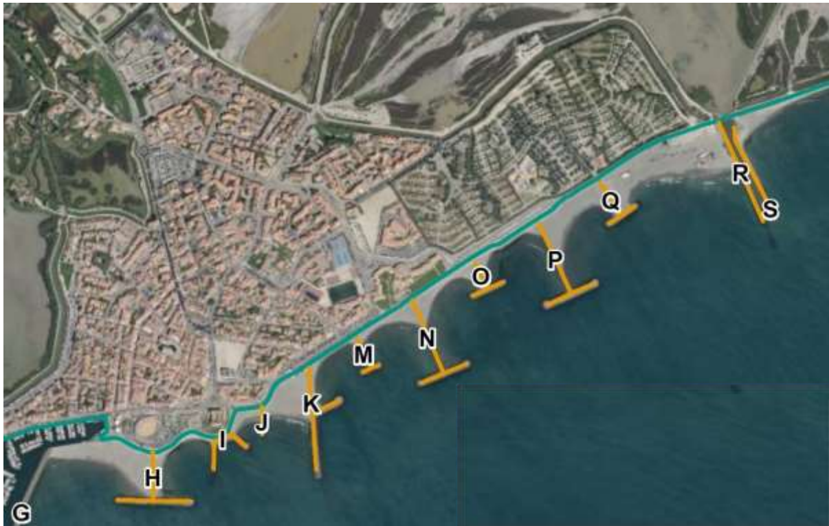
Figure 42. Cartographie des épis et brise lame au droit des Saintes Maries de la mer (2/2)
