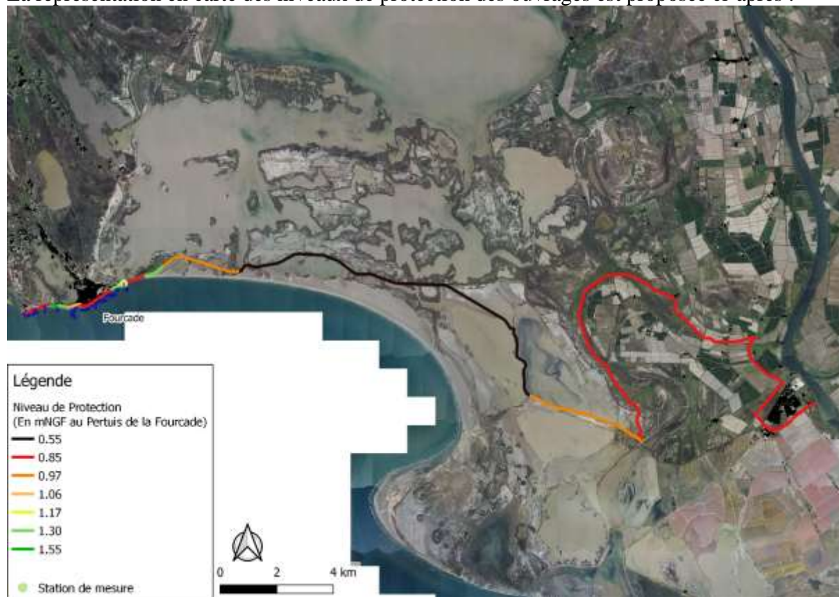
Figure 18. Niveau de protection des ouvrages
