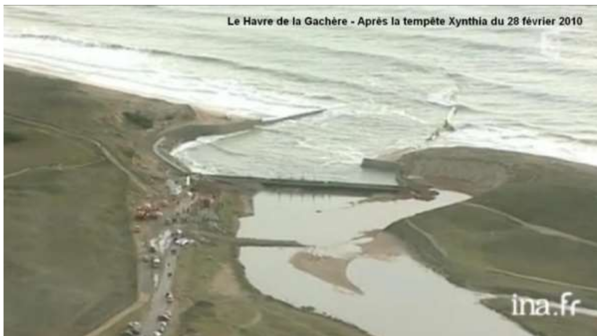
Figure 4. Brèche dans la dune aux abords du barrage de la Gachère (Source INA) – Tempête Xynthia du 28 février 2010.
