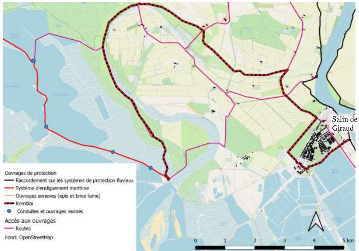
Figure 16. Localisation des ouvrages du système d'endiguement 3/3
