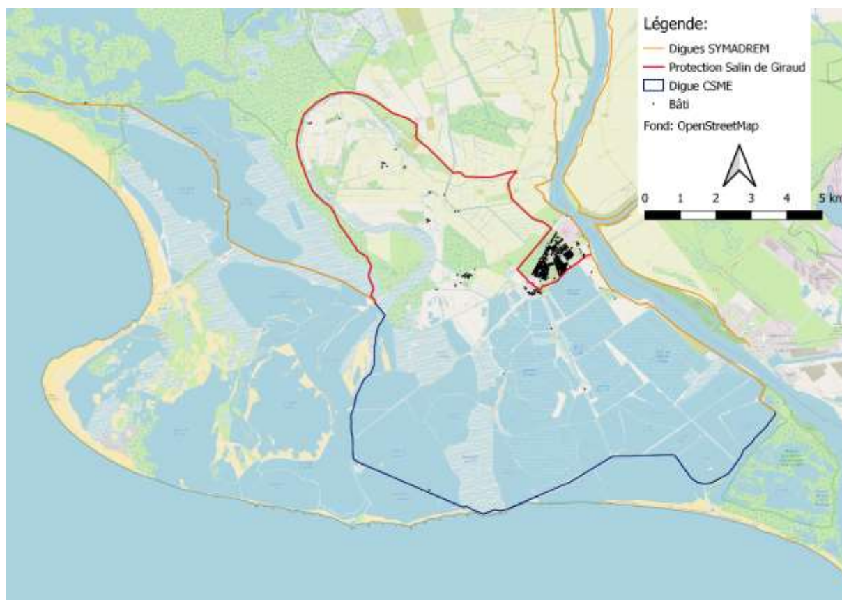
Figure 37. Tracé du système de protection, entre la digue à la mer et le fleuve (rouge)
