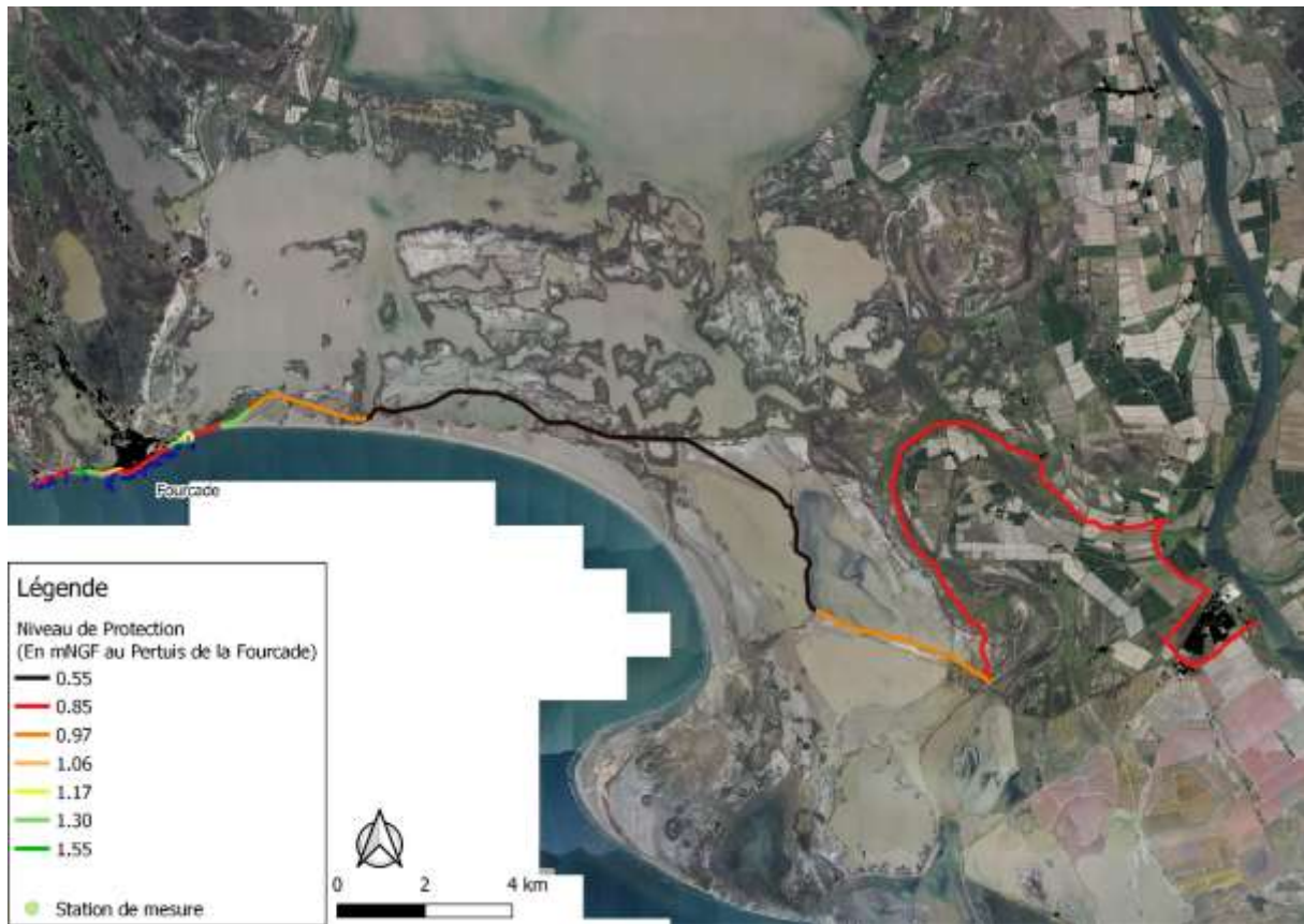
Figure 10. Niveau de protection des ouvrages
