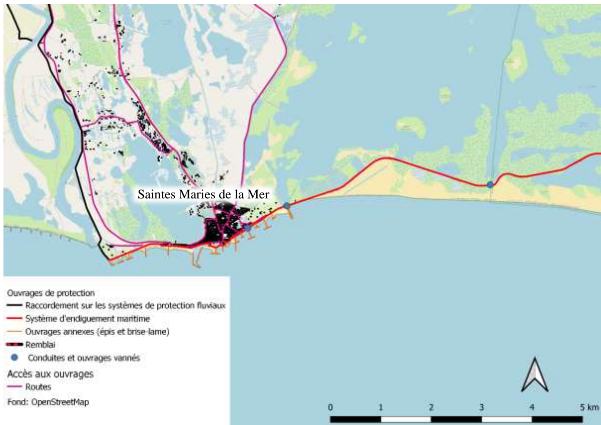
Figure 14. Localisation des ouvrages du système d'endiguement 1/3
