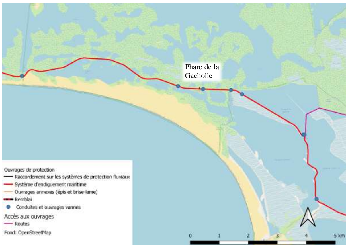
Figure 15. Localisation des ouvrages du système d'endiguement 2/3
