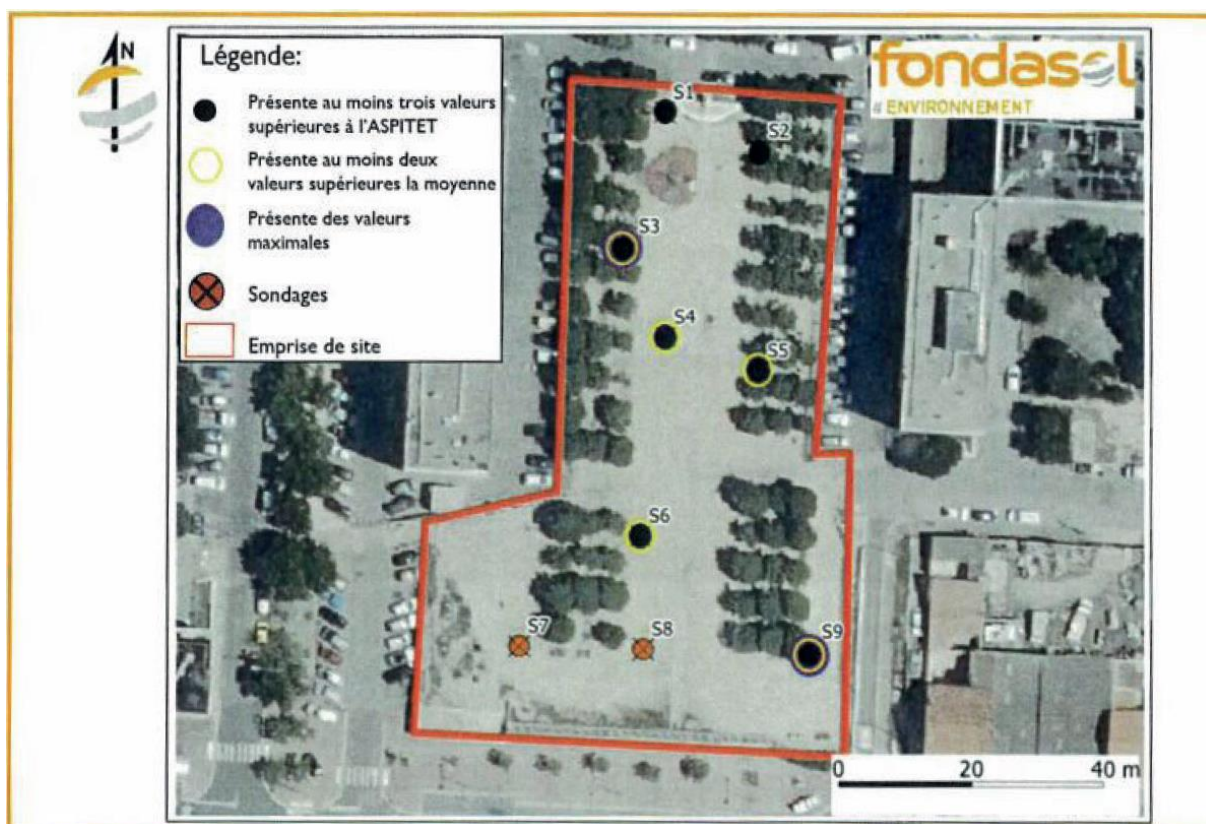
Figure 56 : Localisation des zones concernées par des teneurs remarquables en métaux lourds (Fondasol)
