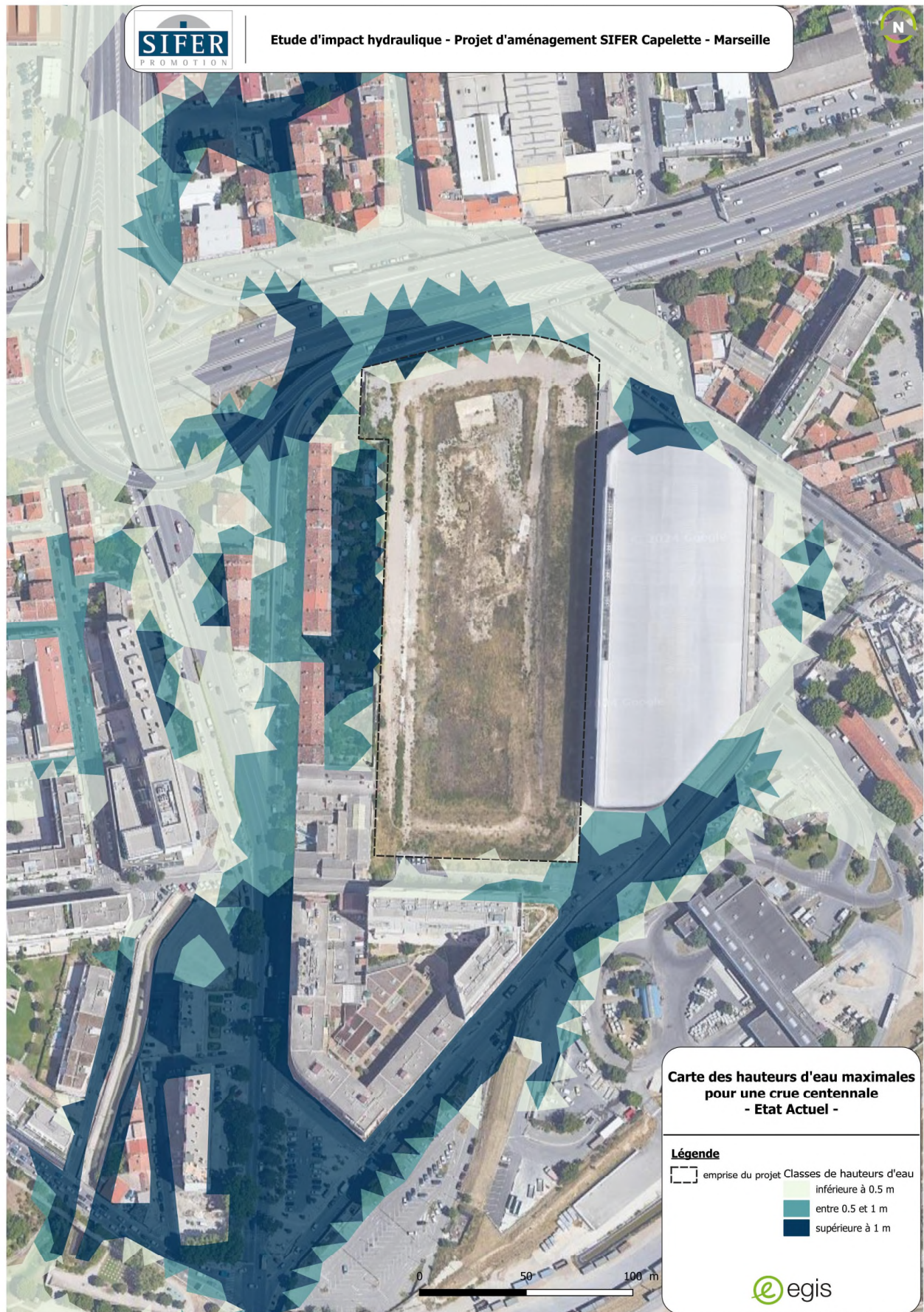
Figure 4 : carte des hauteurs d'eau en état initial
