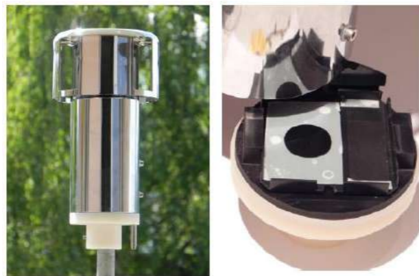
Figure 4 : Illustration du capteur passif de particules PM10
