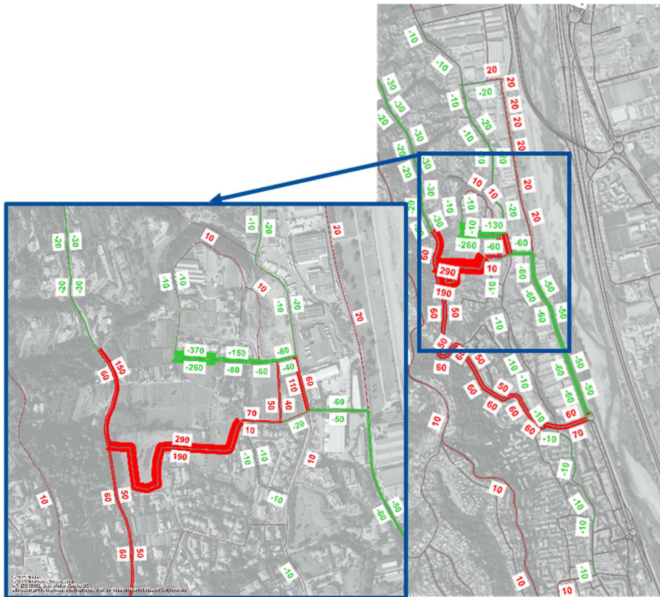
Figure 21 : Carte de différence de trafic à l'HPS - scénario S2 bis vs scénario S2
