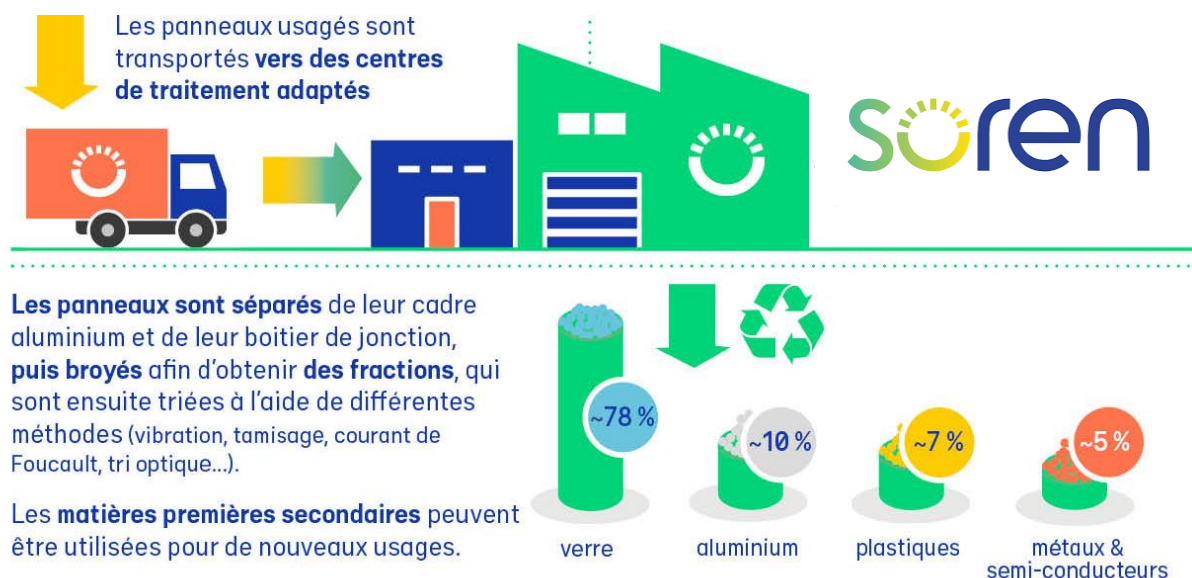
Figure 29 - Le traitement des panneaux photovoltaïques par SOREN. SOREN.
