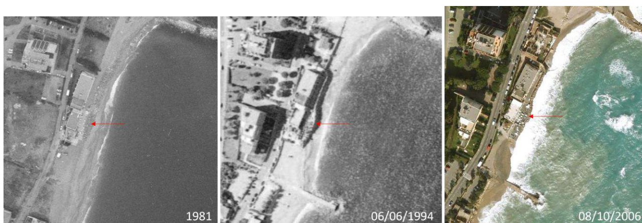
FIGURE 5 – PRESENCE D'ENROCHEMENTS DE PROTECTION DEVANT L'HOTEL/RESTAURANT SITUE A ~100 M DE LA DIGUE SUD DE LA MARINA BAIE DES ANGES AVANT (1981) ET APRES (1994) LA CONSTRUCTION DE L'EPI DES MAURETTES (IMAGES NON-GEOREFERENCEES). LA DERNIERE PRISE DE VUE GOOGLE EARTH QUI MONTRE CES ENROCHEMENTS DATE DE 2006 (A DROITE).
