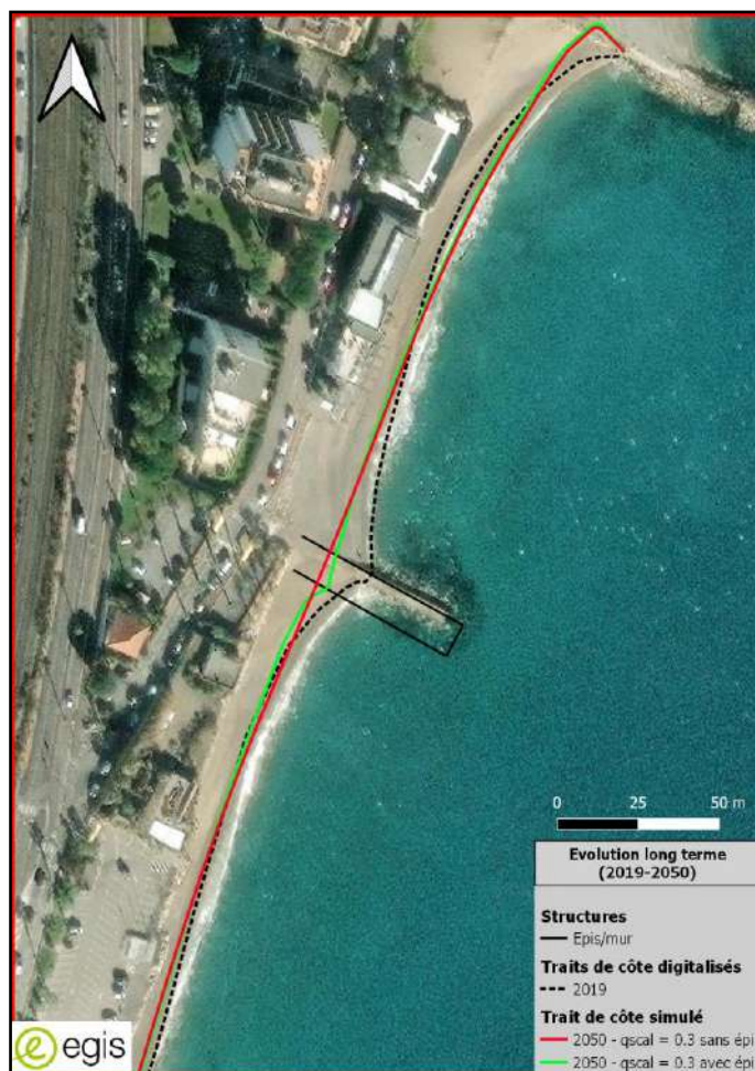
FIGURE 19 – PROJECTION LONG TERME DU TRAIT DE COTE (2019-2050), CALCULE AVEC LE MODELE SHORELINES (QSCAL = 0.3), POUR LES SCENARIOS S1 (VERT, AVEC EPIS) ET S2 (ROUGE, SANS EPIS)
