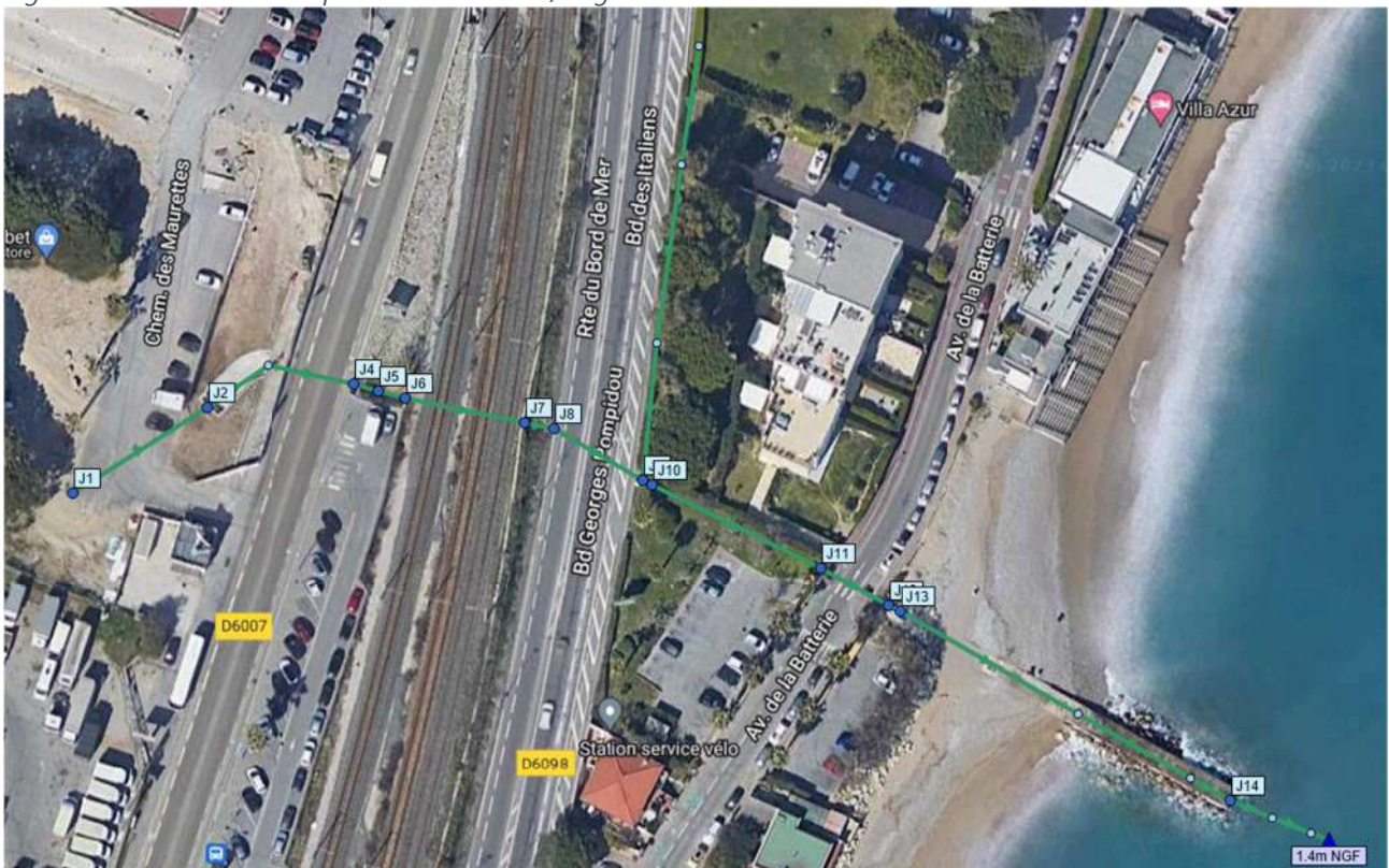
Figure 4 : localisation des points de contrôle / regards
