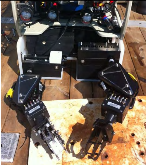
Figure 24 - Skid ROV APACHE SAAS 2500m avec 2 bras (source : SAAS)
