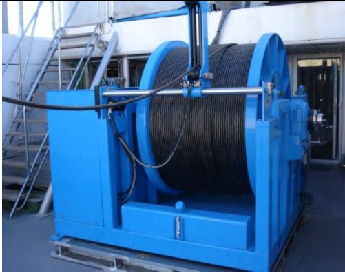
Figure 32 - Treuil électro-porteur ROV DT MARINE (source : SAAS)
