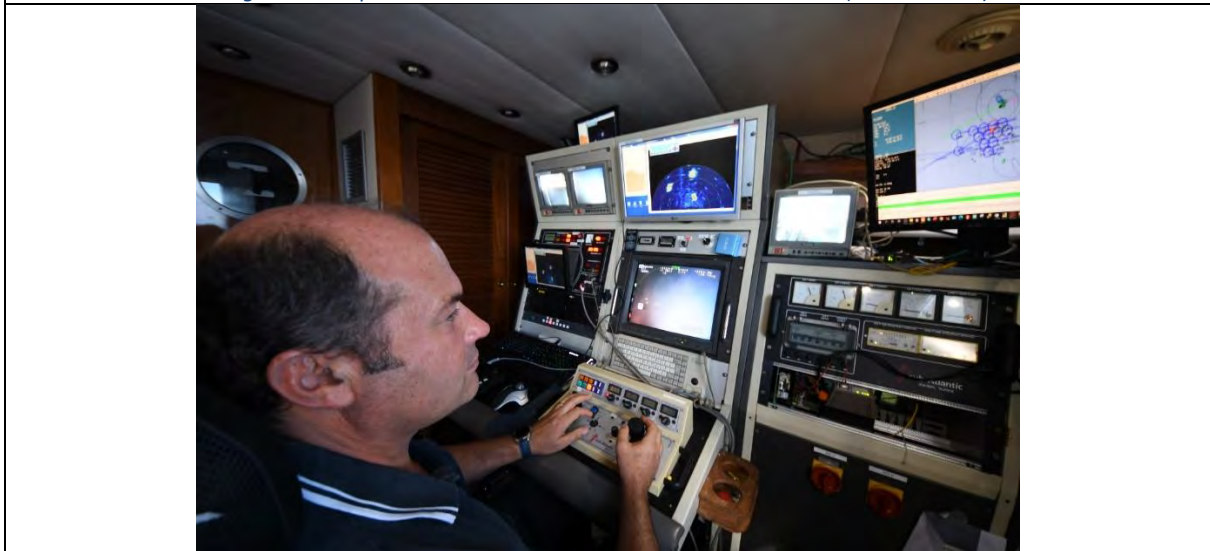
Figure 37 – Poste de pilotage et de contrôle du ROV Apache (source : SAAS)
