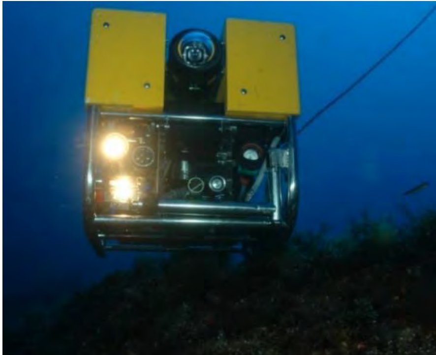
Figure 55 - Le ROV SUPER ACHILLE en opération (source : COMEX).
