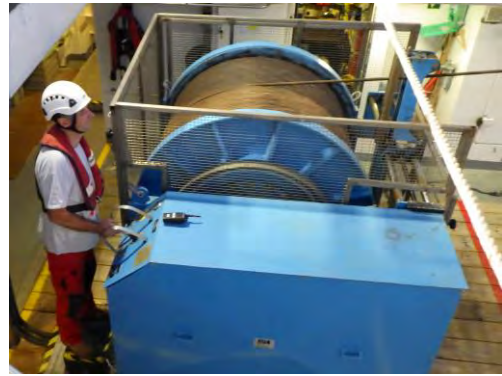
Figure 33 - Pilotage du treuil ROV APACHE SAAS (source : SAAS)
