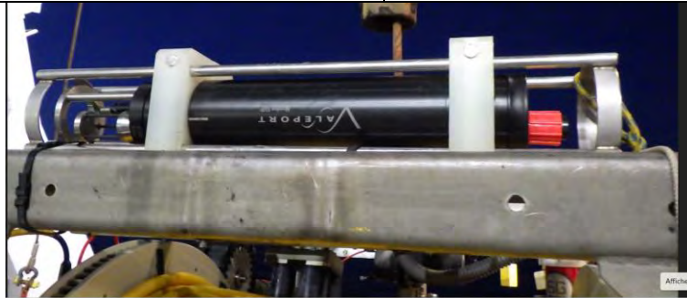
Figure 45 - Profileur SVP sur cage ROV (source : SAAS)
