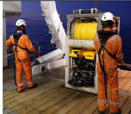
Figure 35 - Mise à l'eau en sécurité avec le portique arrière (source : SAAS)
