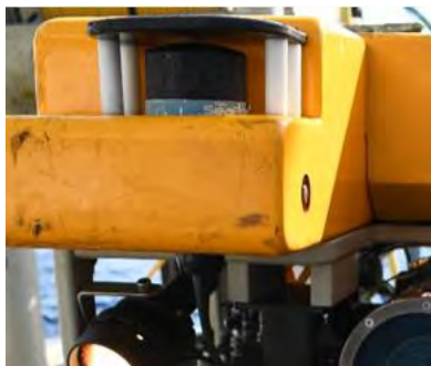
Figure 15 - Sonar installé sur le ROV (source : SAAS)
