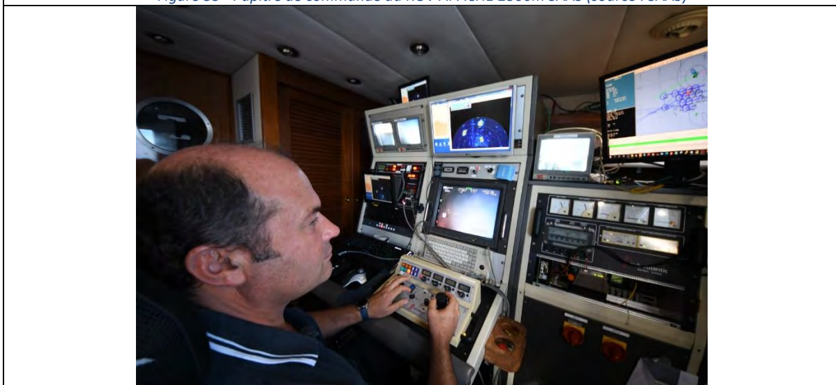
Figure 36 – Poste de pilotage et de contrôle du ROV Apache (source : SAAS)
