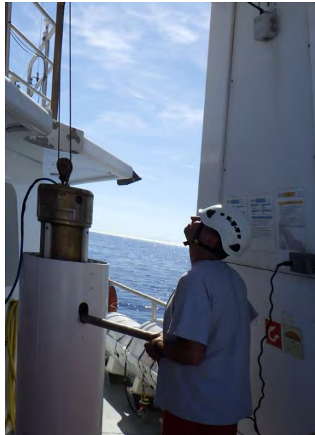
Figure 43 - Mise en œuvre de la perche USBL (source : SAAS)
