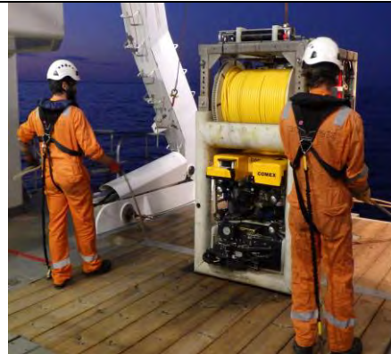
Figure 34 - Mise à l'eau en sécurité avec le portique arrière (source : SAAS)
