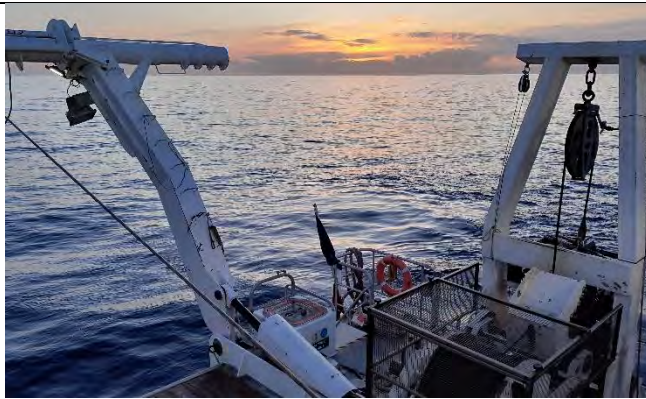
Figure 67 - Portique déployé (source : SAAS)
