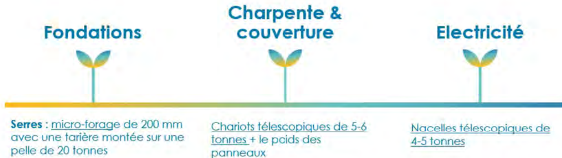
Figure 13 : Les différentes étapes de la phase chantier d'une installation agricole photovoltaïque chez Technique solaire
