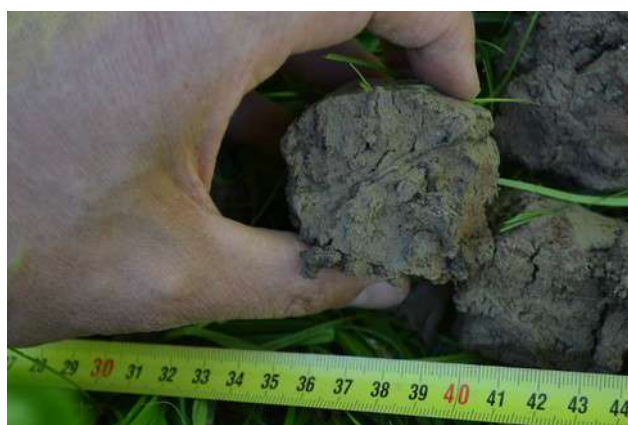
Fluvisol réductique témoignant la présence d'une nappe permanente à faible profondeur (environ 1 m)
