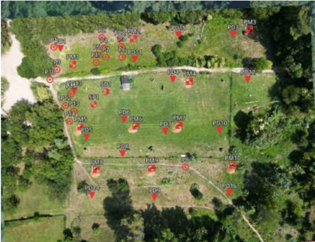
Figure 25. Localisation des points de fouille PM à la pelle effectués sur la zone du projet – Dgéotec, juillet 2023
