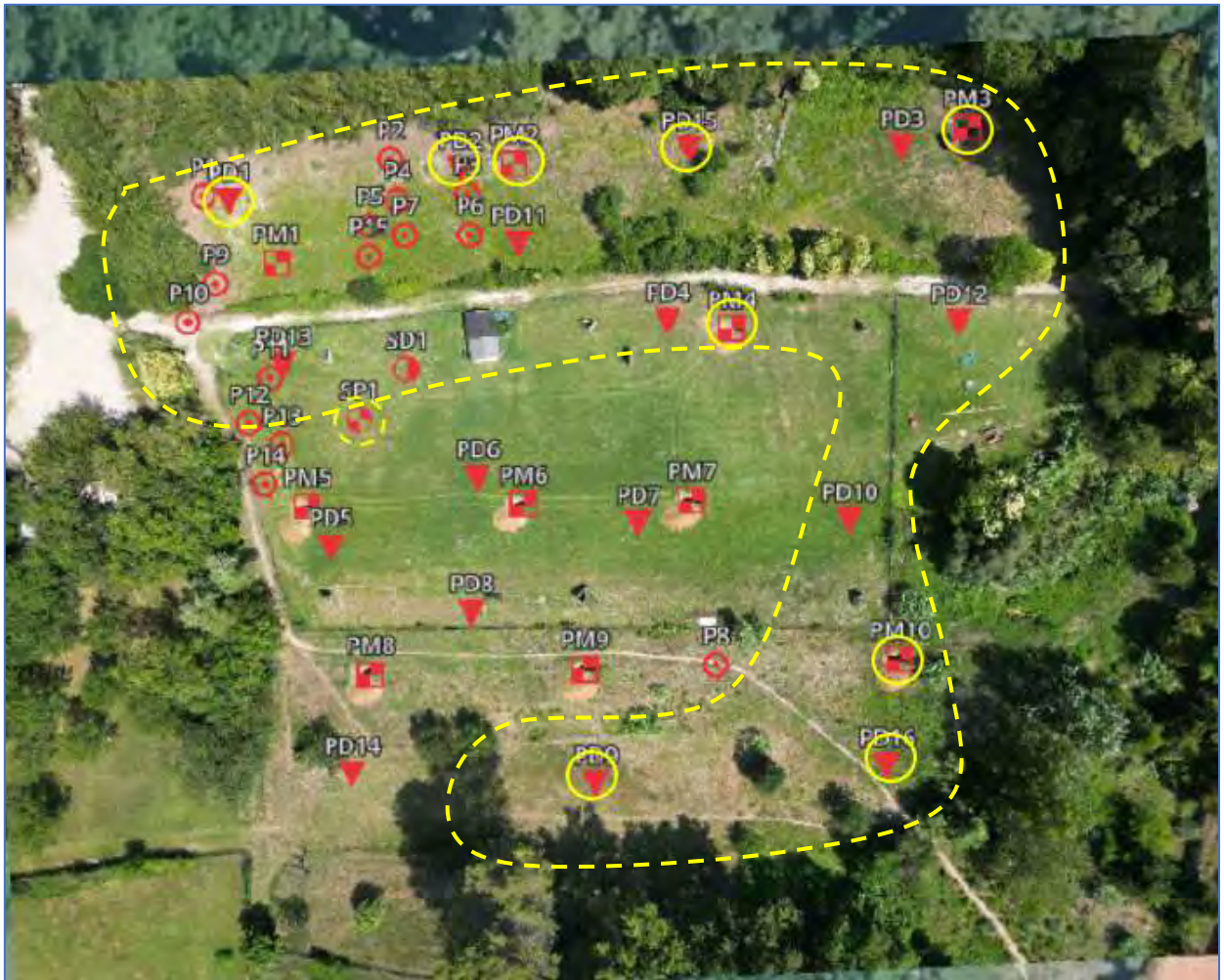
Sondages avec épaisseurs supposée supérieure à 1m de remblais de surface, et zone de recouvrement de remblais supposée
