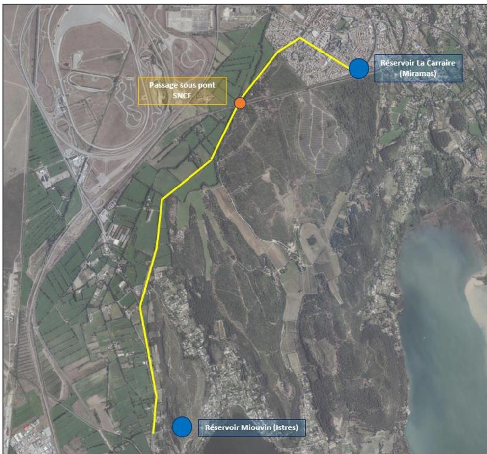
Figure 1 : Tracé de la canalisation d'interconnexion
