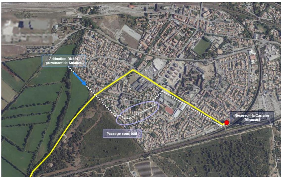
Figure 7 : Passage sous bâti de la canalisation DN400 d'adduction du réservoir de La Carraire (Miramas)
