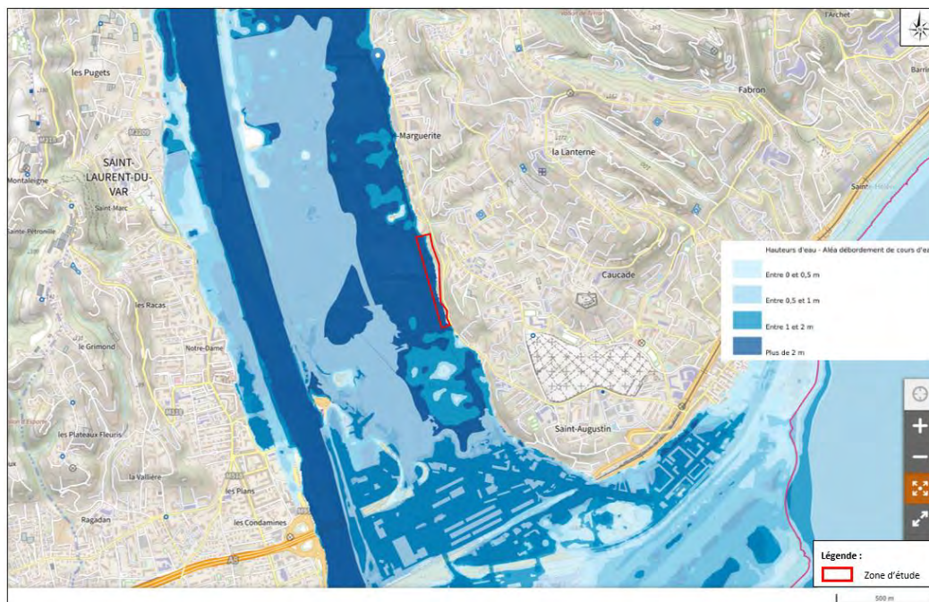
Figure 21 : Carte d'aléa de débordement de cours d'eau fréquent ou décennal (Source : Géorisques)
