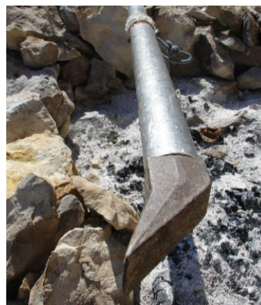
Figure 5 : Matériel utilisé pour les purges du front rocheux
