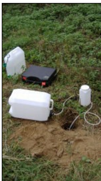
Matériel de mesure de la perméabilité de PROVENCE GEO CONSEILS , de marque SDEC.
