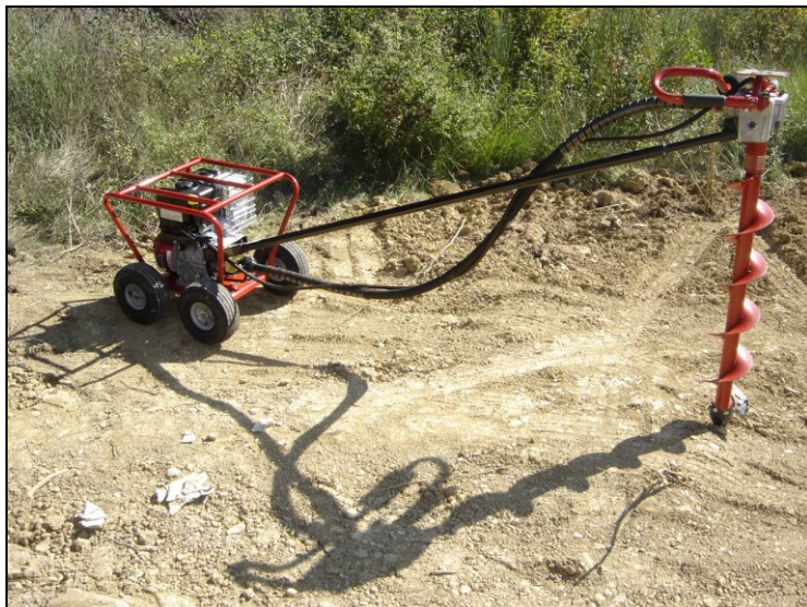
Tarière mécanique 8 CV montée sur châssis. Exemple de sondage de reconnaissance « profond » en DN 150 mm.
