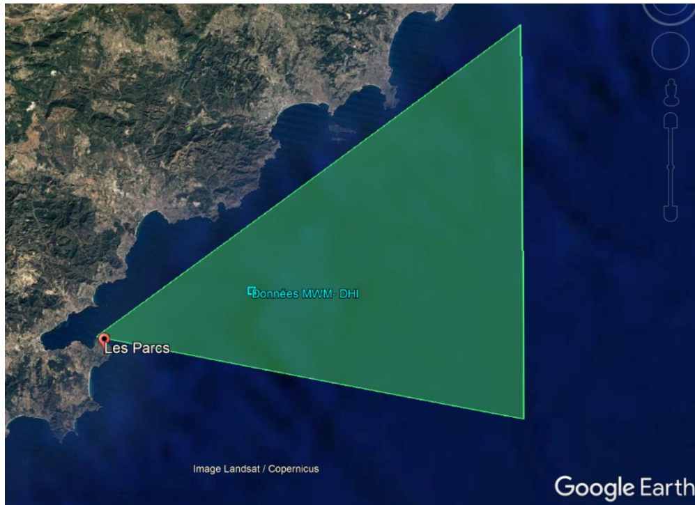
Figure 21 : Secteur d'exposition de la zone de mouillage à la houle du large
