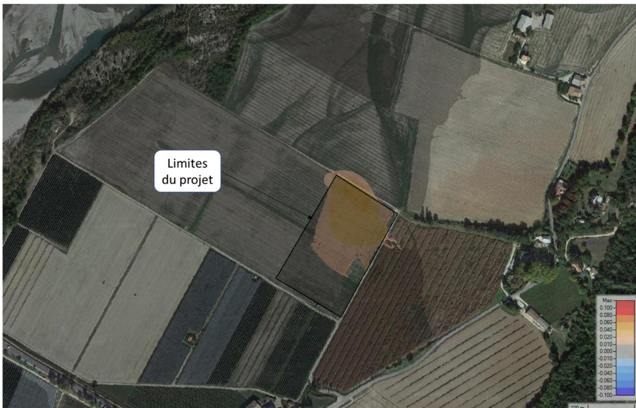
Figure 16 : Différences de hauteur d'eau maximale théorique entre état initial et état final (m) - Q100
