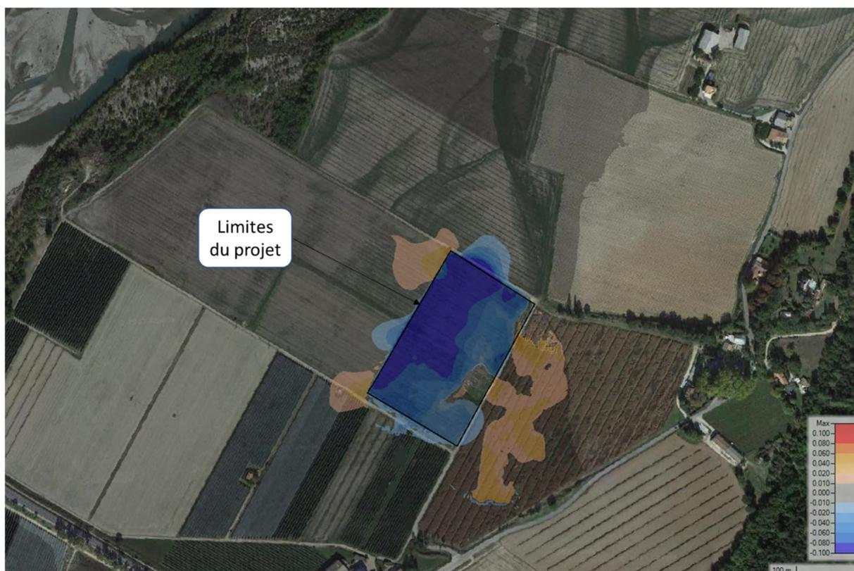
Figure 18 : Différences de vitesses d'écoulement maximales théoriques entre état initial et état final (m/s) - Q100
