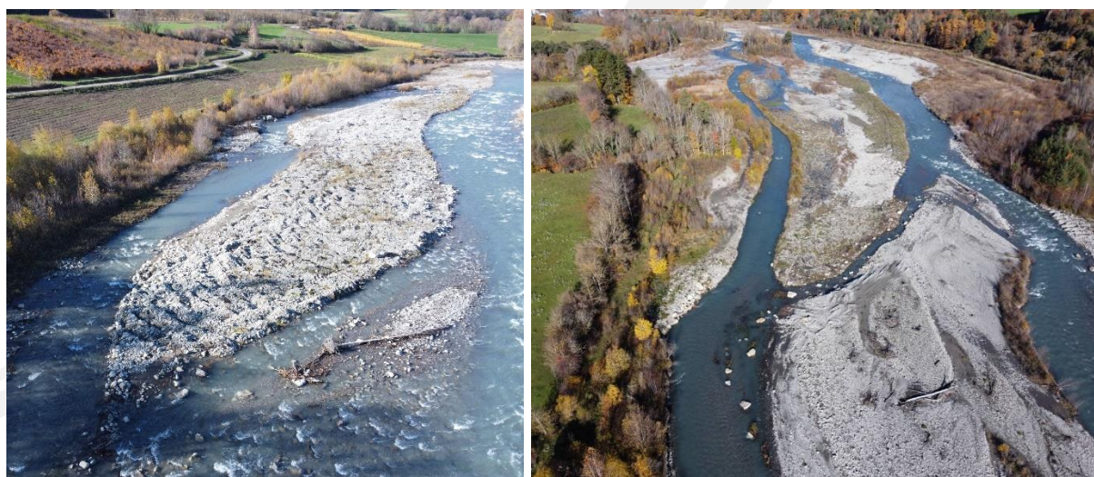
Figure 29 : Banc déboisé et scarifié à gauche et chenal secondaire restauré à droite (travaux CLEDA 2022)
