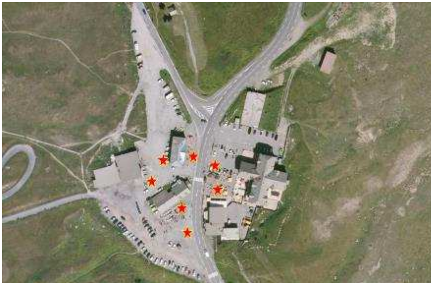
Figure 10 : sondages complémentaires à réaliser
