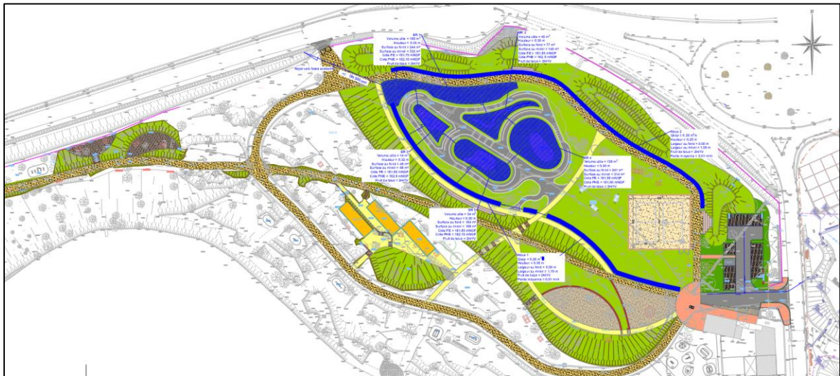
Figure 24 – Implantation des ouvrages de rétention
