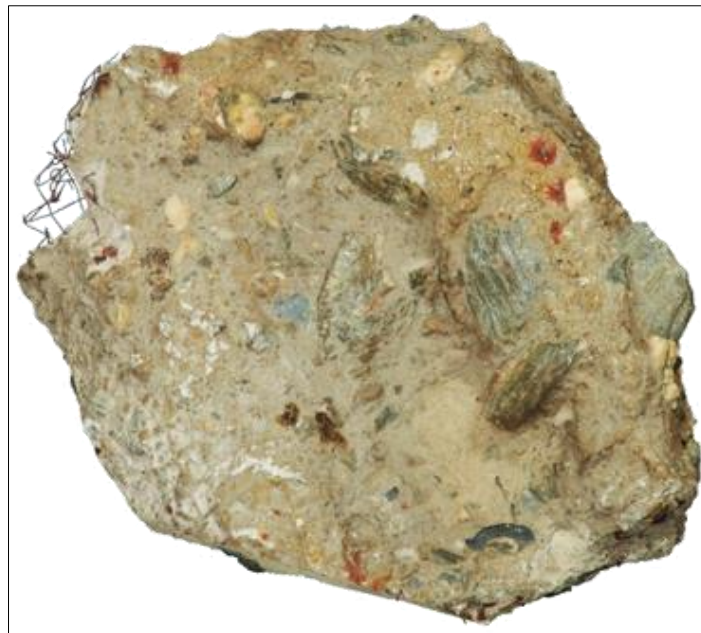
Figure 90 : Agrégat formé à partir du processus Géocorail – GEOCORAIL
