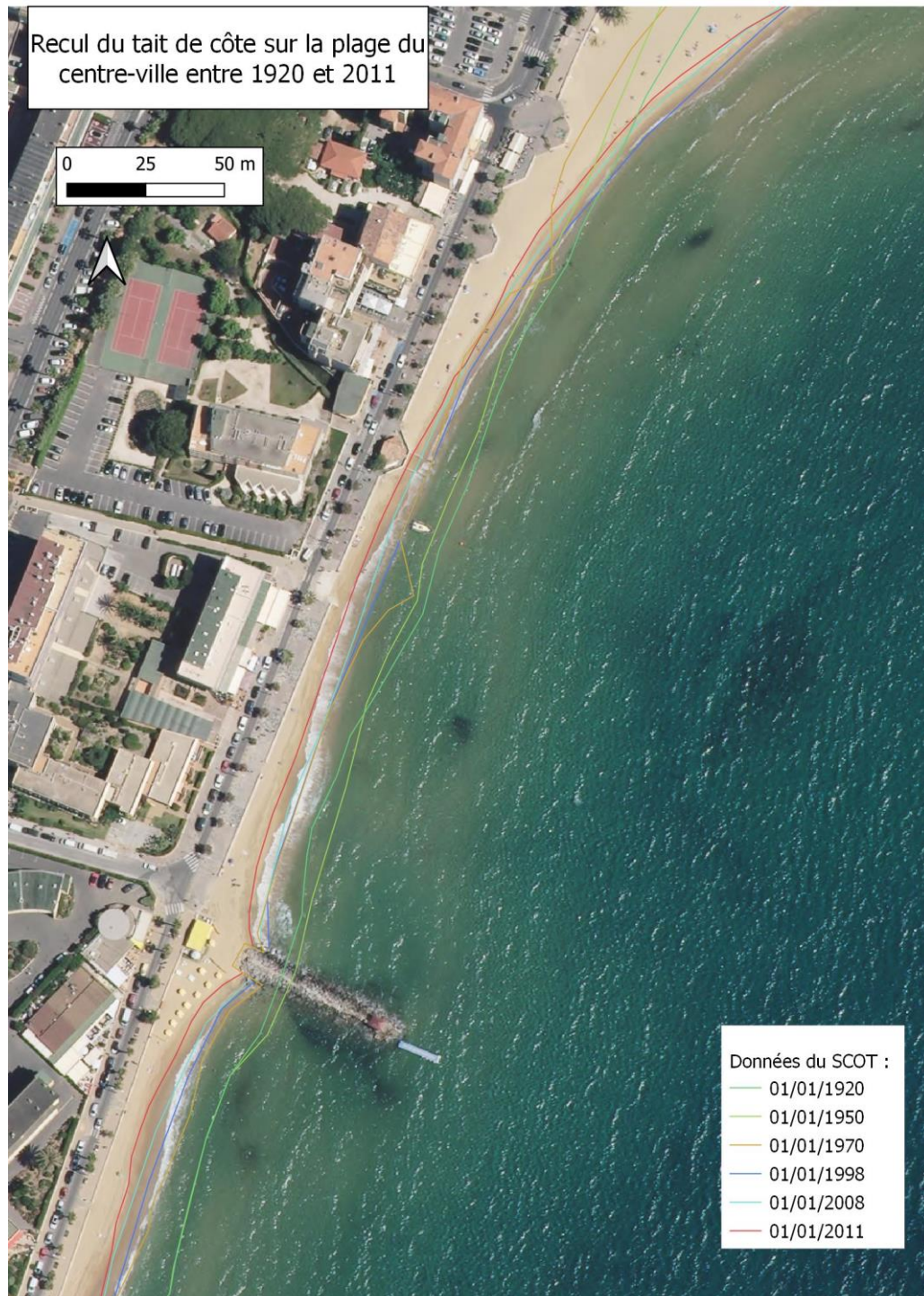
Figure 22 : Evolution de la plage entre 1920 et 2011 – Etude BRGM pour le SCOT Provence Méditerranée
