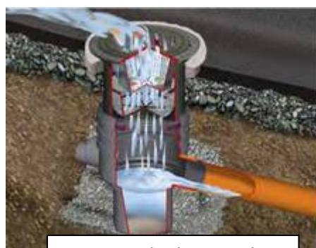
Exemple de regard filtrant sous chaussée
