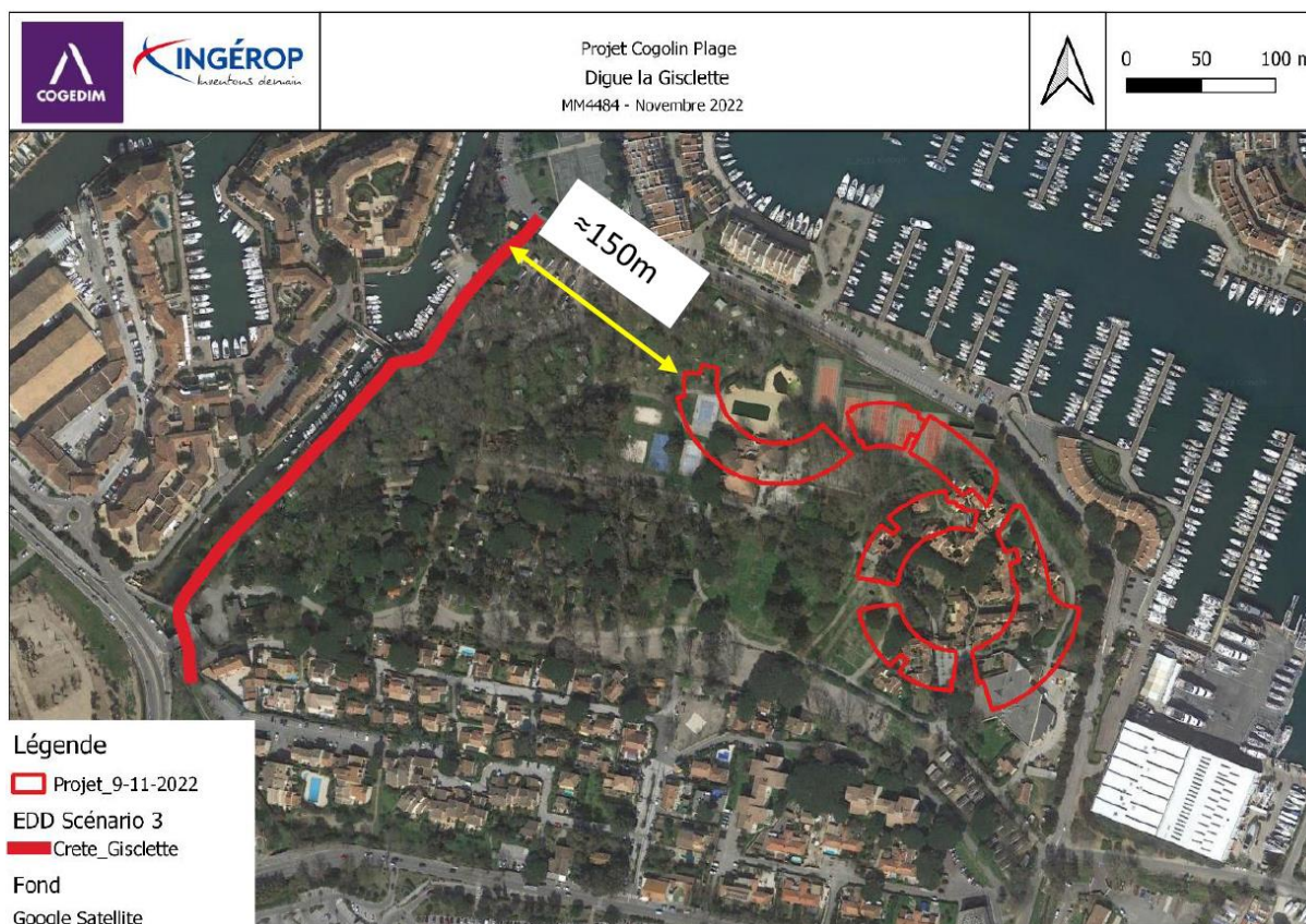
Bande de précaution de la digue de la Gislette Etude hydraulique réalisée par INGEROP
