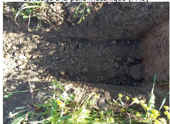
Sondage à la pelle mécanique (PM4)
