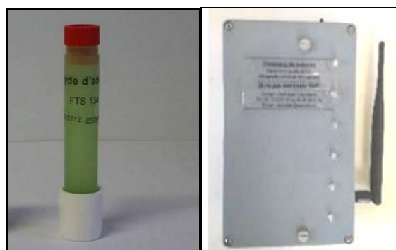
Figure 55 : Tube passif pour NO 2 et micro-capteur laser
