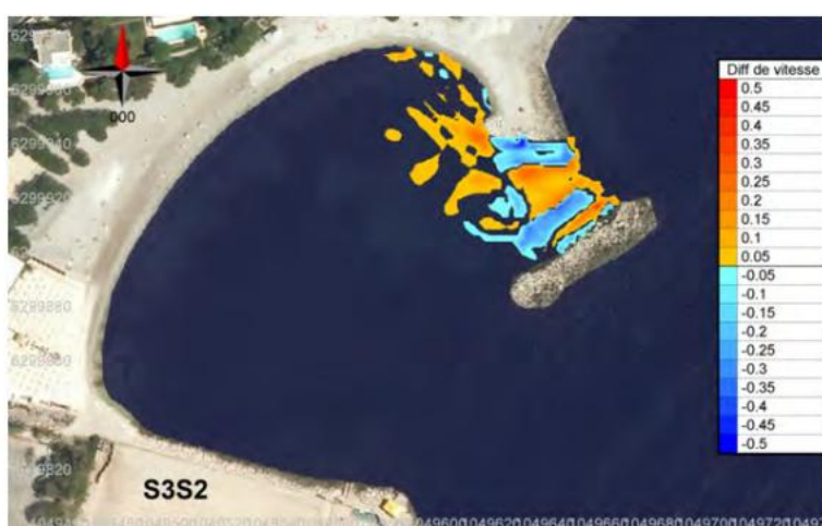
Figure 7 : Résultats de la comparaison entre les simulations de courantologies avant et après travaux.
