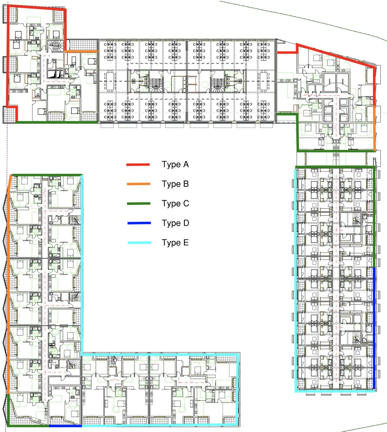
Figure 8 : Isolements des façades du R+6
