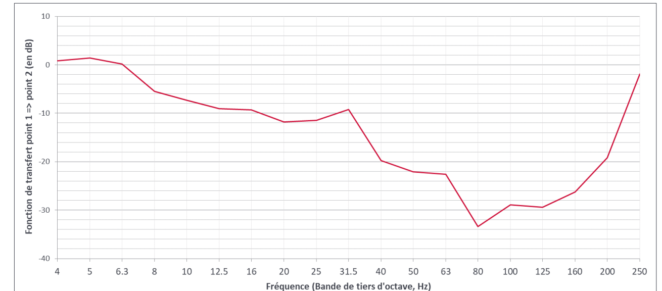
Figure 10 : Fonction de transfert calculée du point 1 => point 2 sur la base des 9 trains mesurés en simultanée
