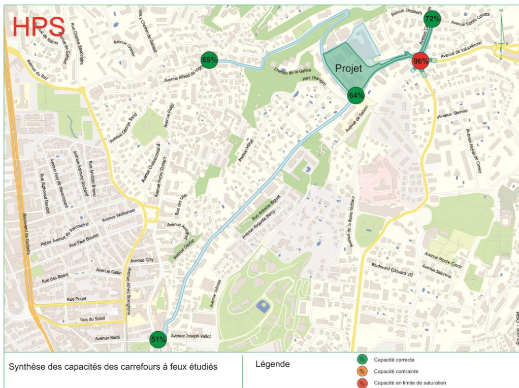
Figure 31. : Capacité des carrefours à feux en HPS
