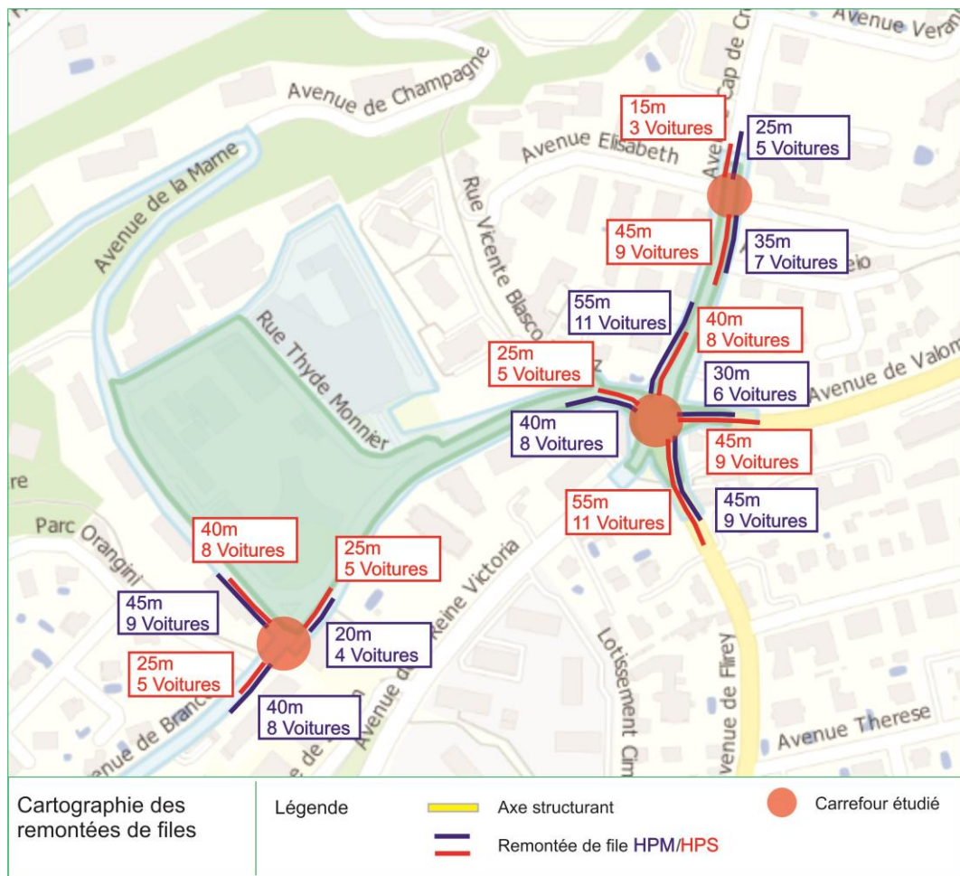
Figure 27. Remontées de files autour du projet
