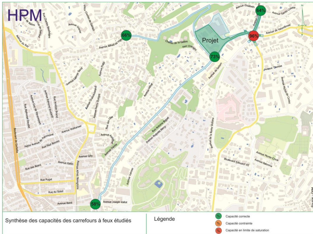
Figure 30. : Capacité des carrefours à feux en HPM
