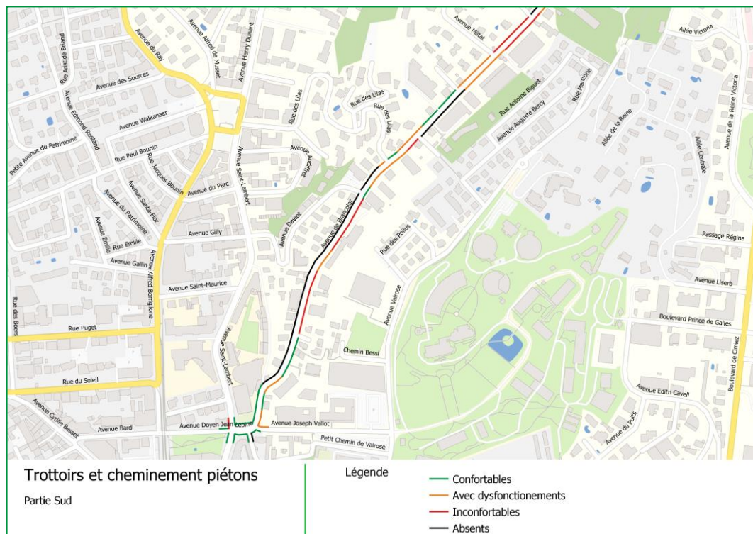
Figure 7. Analyse des trottoirs partie sud
