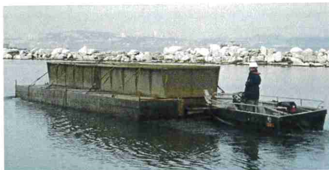
Figure 3 : Exemple de barge de transport des sédiments
