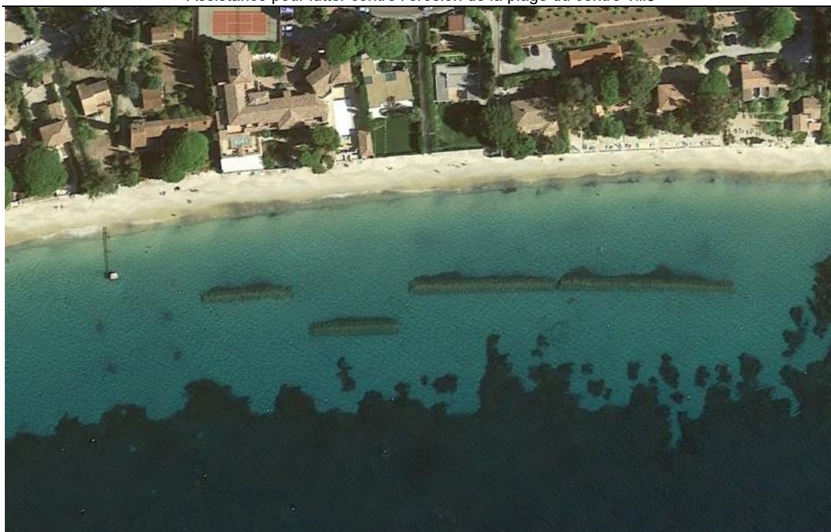
Figure 5. Vue en plan de la plage de Cavalière au Lavandou où des protections sous-marines ont été installées, googleEarth
