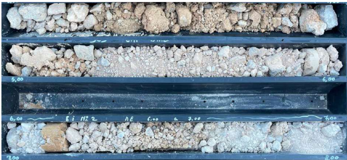
Figure 17 : Photographie des sables silto-argileux entre 4 et 8m lors du forage SC3
