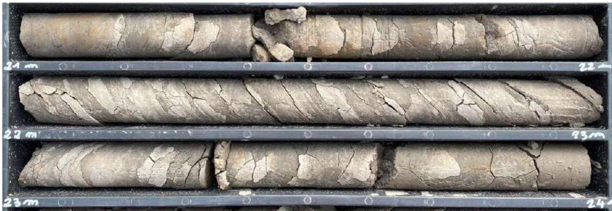
Figure 23 : Photographie des marnes argileuses schistosées entre 21 et 24m lors du forage SC4
