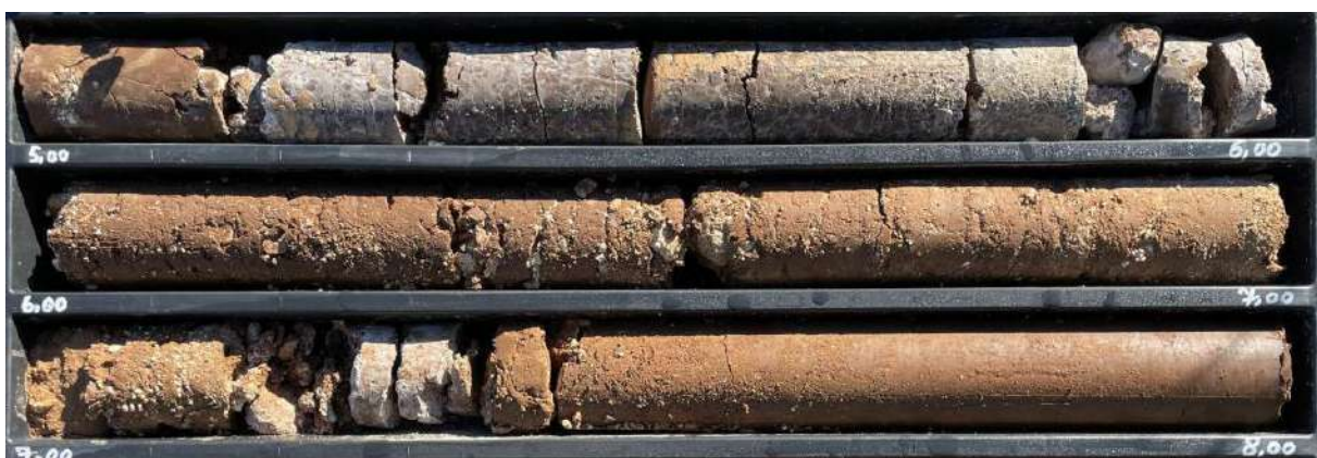
Figure 16 : Photographie des sables silto-argileux entre 5 et 8m lors du forage SC2
