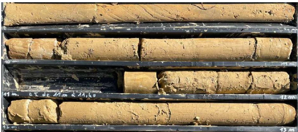
Figure 22 : Photographie des marnes argileuses entre 9 et 13m lors du forage SC4
