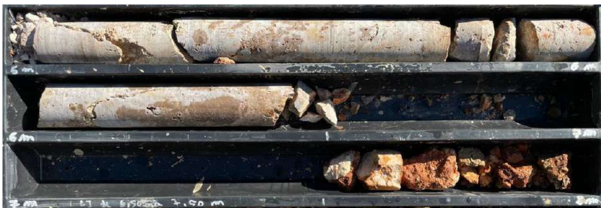
Figure 21 : Photographie des conglomérats calcaires cimentés entre 5 et 8m lors du forage SC4
