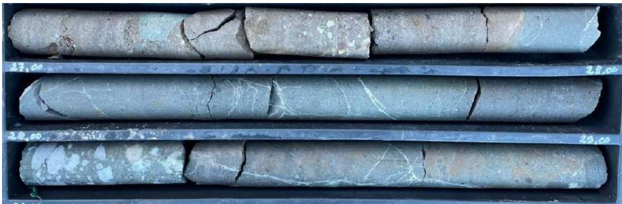
Figure 20 : Photographie des conglomérats andésitiques entre 27 et 30m lors du forage SC3
