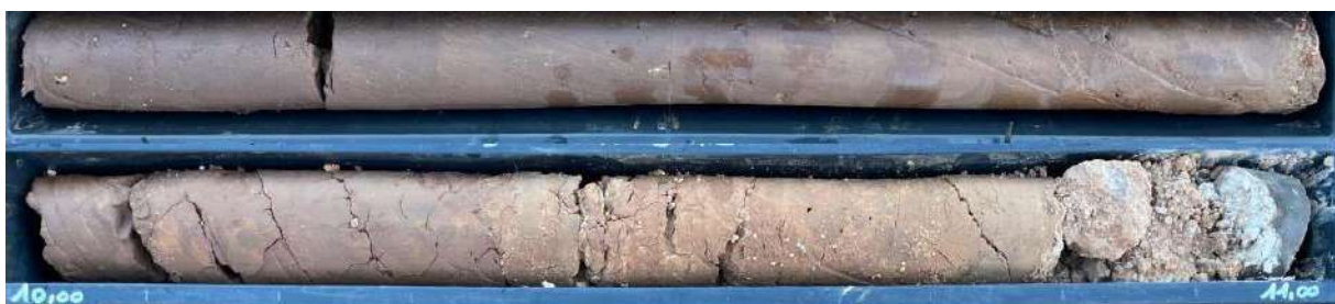
Figure 18 : Photographie des argiles silteuses entre 9 et 10,9m lors du forage SC3
