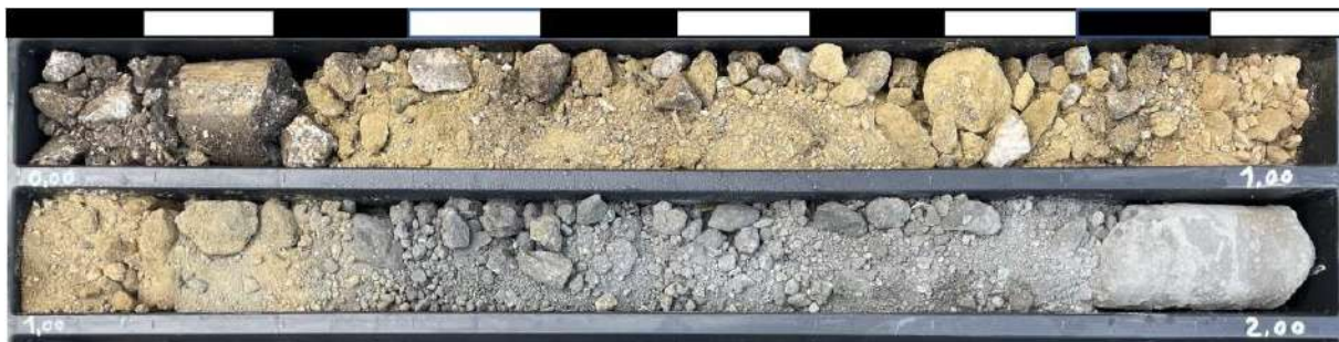
Figure 13 : Photographie des éboulis de pente entre 0 et 2m lors du forage SC1
