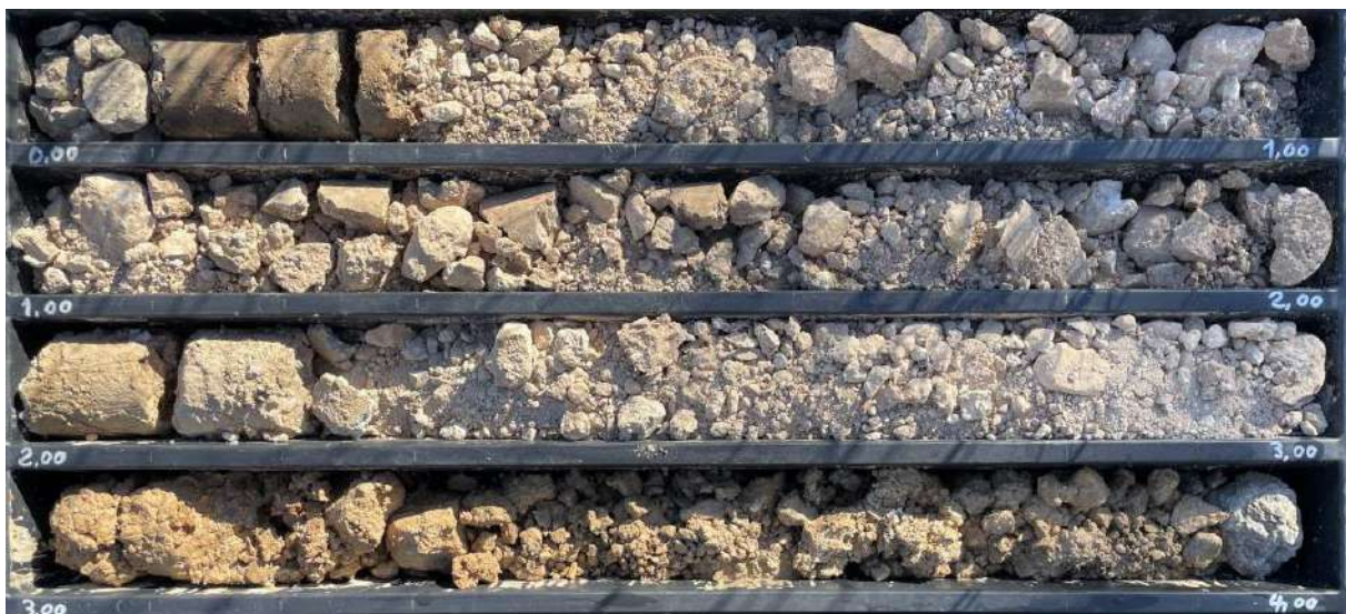
Figure 15 : Photographie des éboulis de pente entre 0 et 4m lors du forage SC2
