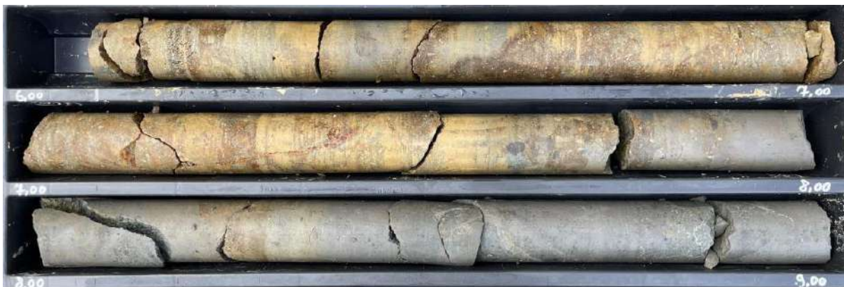
Figure 14 : Photographie des conglomérats andésitiques entre 6 et 9m lors du forage SC1
