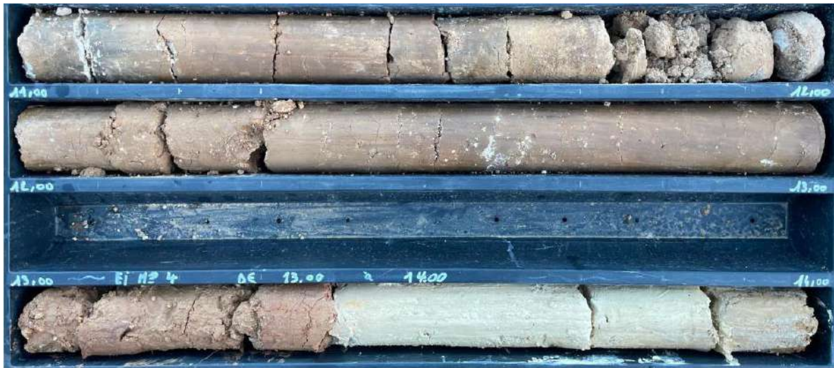
Figure 19 : Photographie des sables silto-argileux entre 11 et 15m lors du forage SC3
