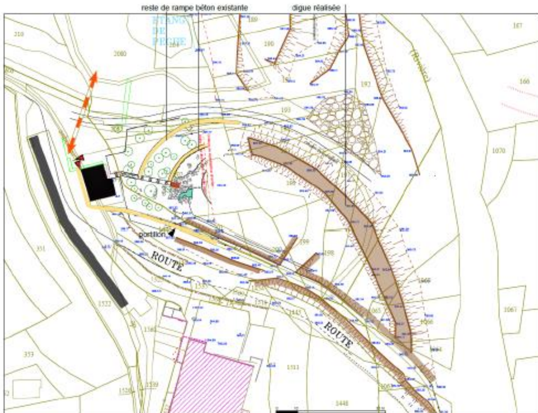
La topographie à jour, le positionnement de la digue coté Vésubie et de l'ouvrage de protection coté Cervagné sont des préalables
