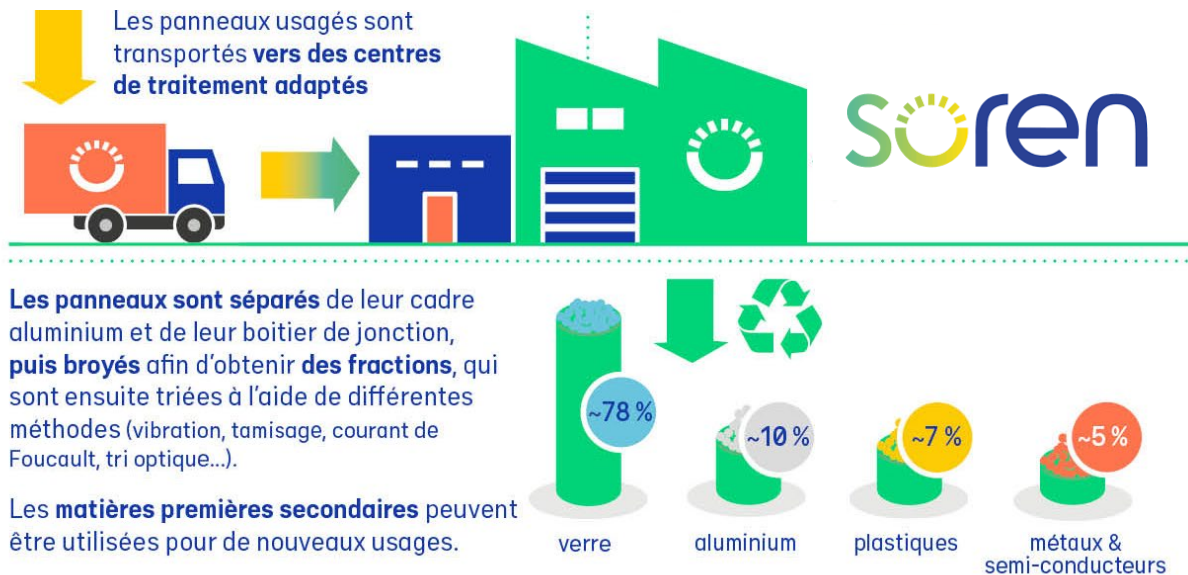
Figure 25 - Le traitement des panneaux photovoltaïques par SOREN. Source : SOREN, en ligne.
