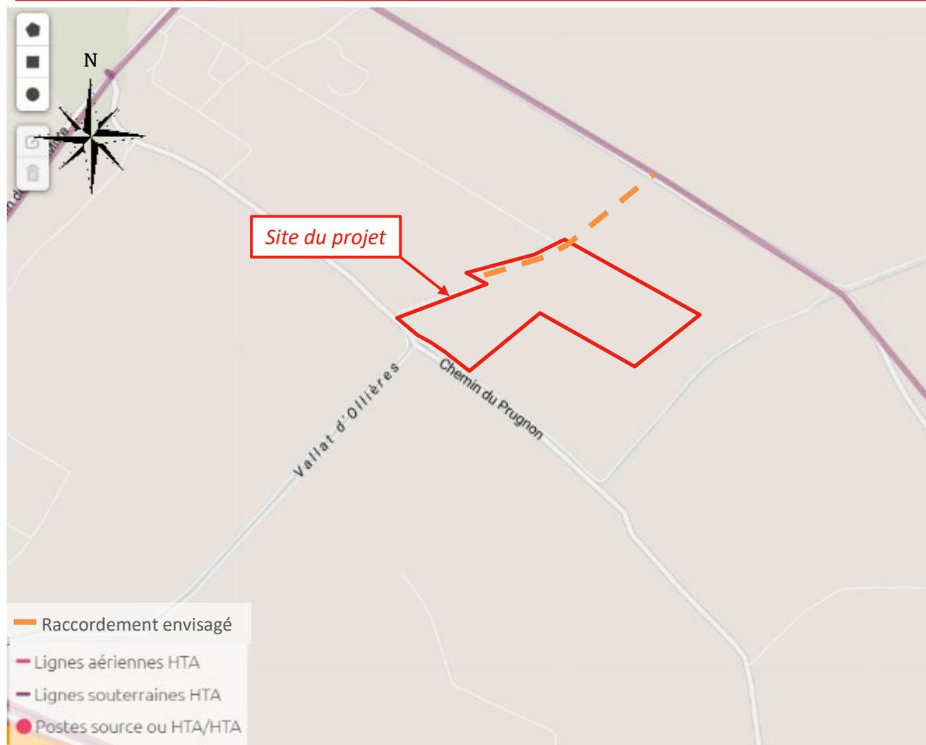
Le tracé du raccordement sera réalisé sur la parcelle du projet pour rejoindre le chemin de St Mitre et la ligne HTA Enedis la plus proche.
