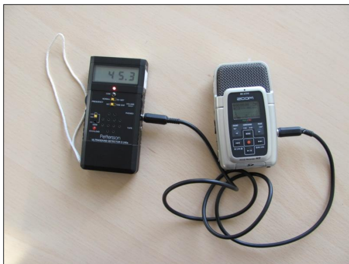
PETTERSSON D240X couplé à un enregistreur numérique
