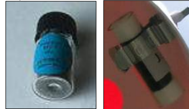
Tube pour mesurer les BTEX
