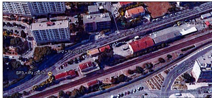
Figure 12. Implantation des piézomètres spécifiques à la nappe des Poudingues
