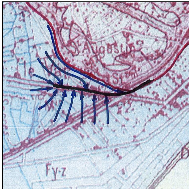
Figure 14 : Nappe superficielle – lignes de courant vraisemblables en phase travaux
