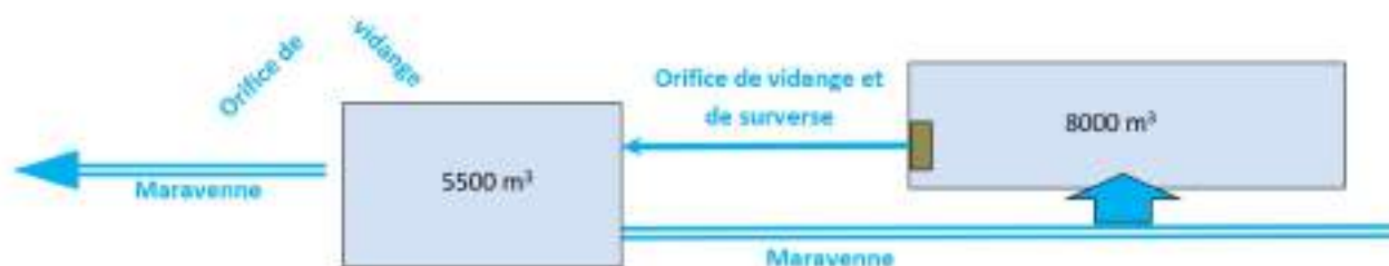
Figure 14 : Croquis de principe d'implantation du volume de rétention sur le cours d'eau - scénario 2022
